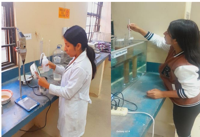
Figura 18: Ensayo por Hidrómetro
