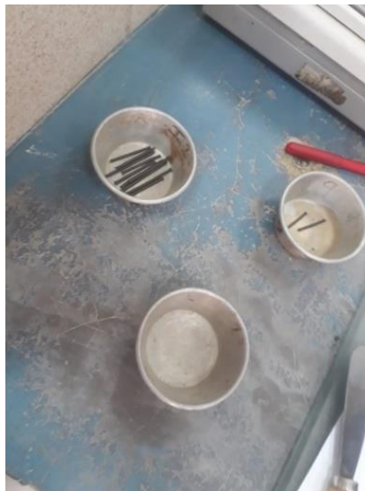
Figura 11: Prueba del límite plástico
