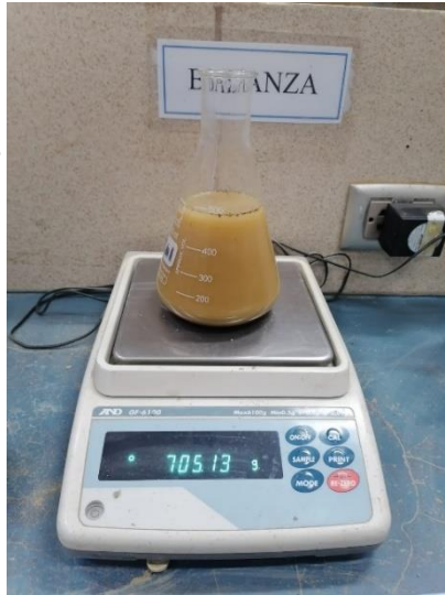
Muestra de frasco volumétrico con suelo fino.
