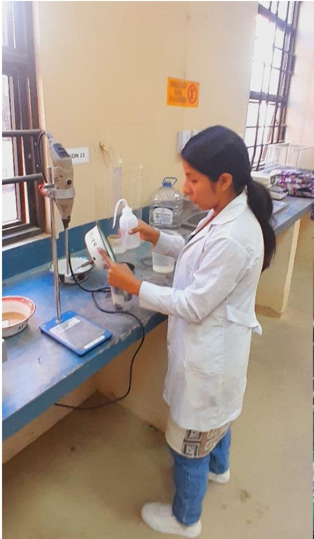
Proceso del ensayo del Densímetro en el Laboratorio de suelo.
