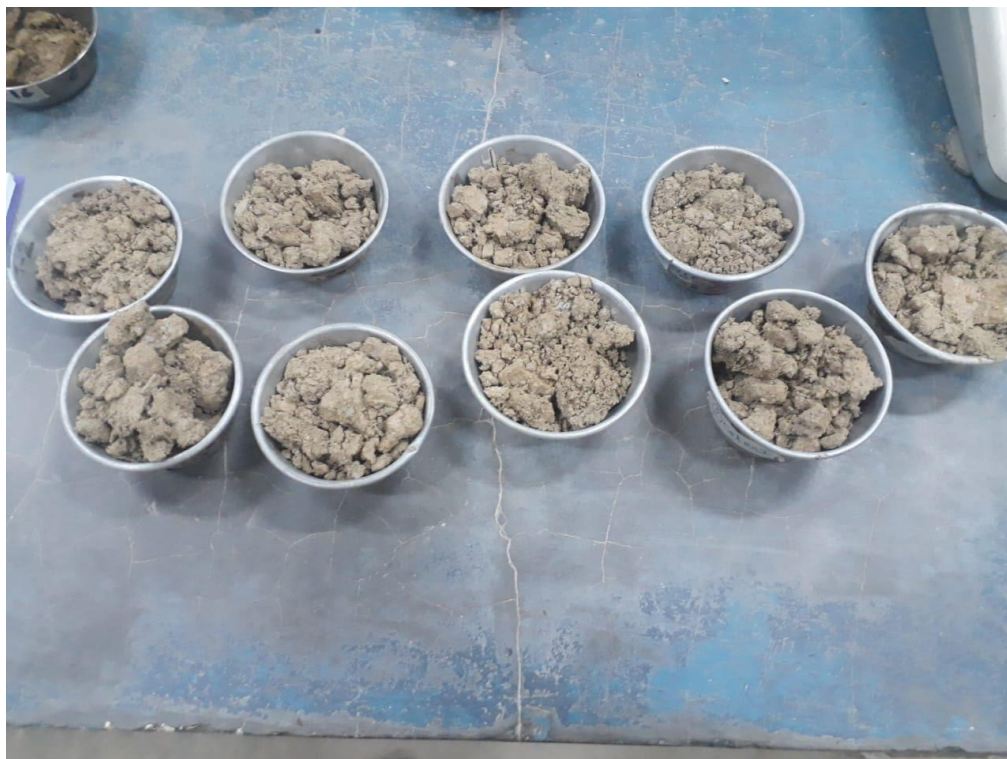
Muestra de suelo seco sacado del horno de Laboratorio de Suelos
