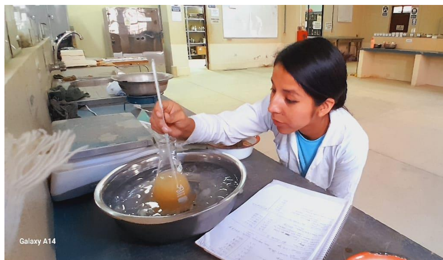
Calibración de la temperatura en el frasco volumétrico.
