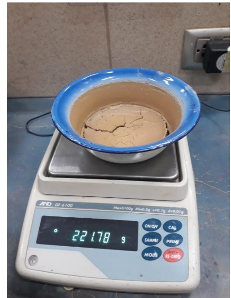
Muestra suelo fino en platos antes y después de entrar al horno de laboratorio.
