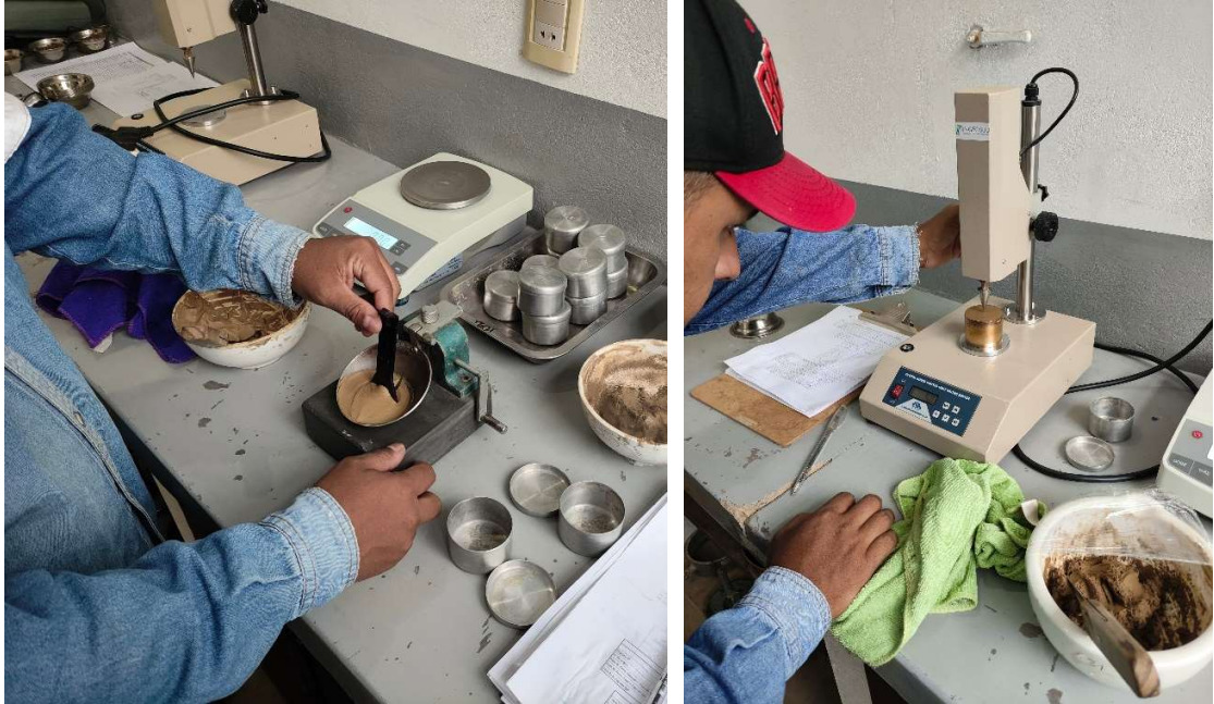
Determinación de limite liquido según la norma ASTM D-4318 (imagen izquierda) y BS 1377-2 (imagen derecha)
