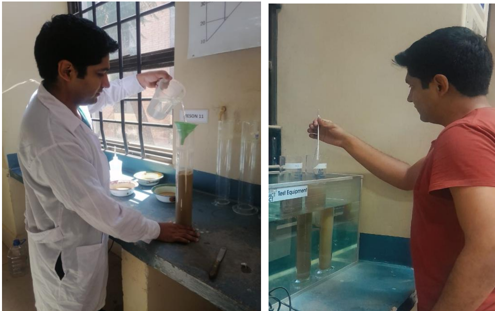
Figura 32: Realización ensayo del densímetro 152H
