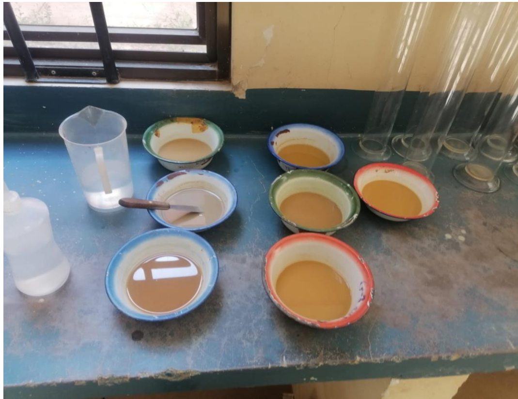
Figura 30: Muestra de suelo arcilloso en reposo con defloculante por 24 horas
