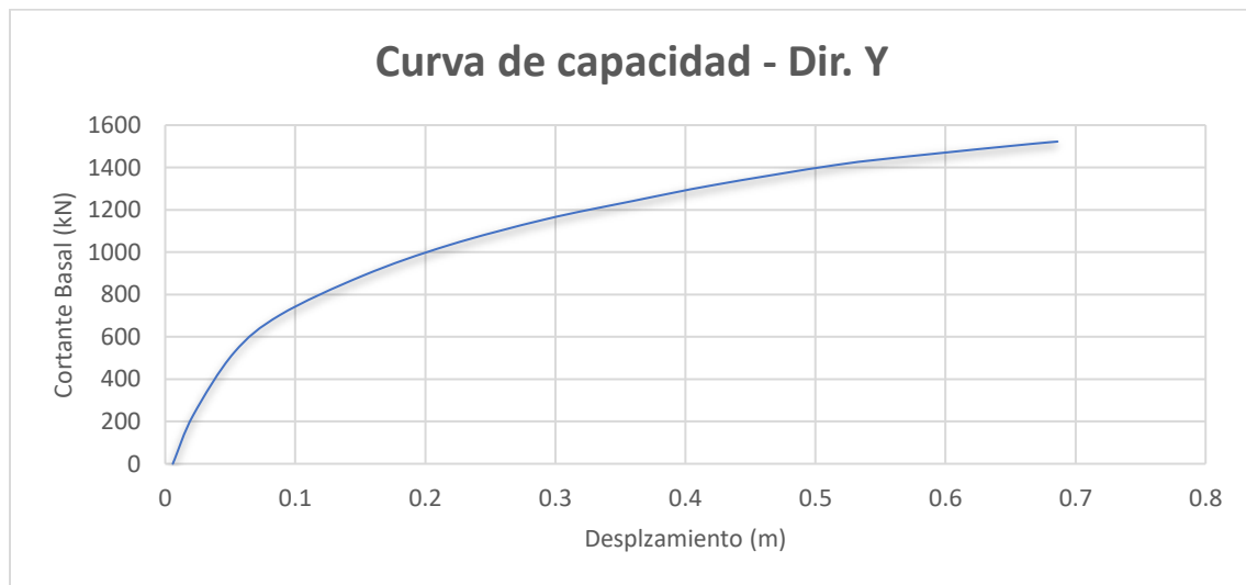
Gráfico 7. Curva de capacidad en dirección Y, edificio Parque Bolivar.
