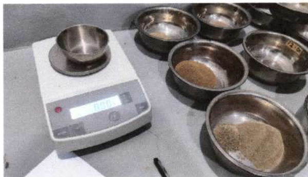
Granulometría por tamizado y pesaje de suelo retenido en balanza de precisión 0,01 gr.
