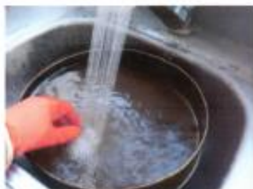
Lavado de muestras por tamiz N°200, posterior secado de muestras en horno a temperatura 110 \pm 5^\circ\text{C} .
