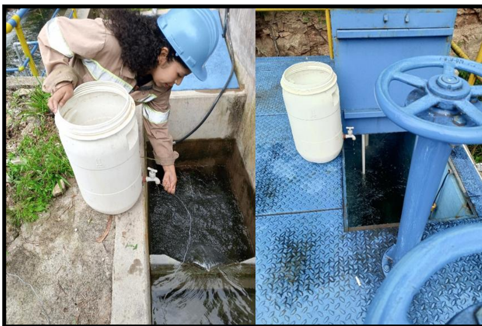
Figura 25 Adición del trazador químico.
