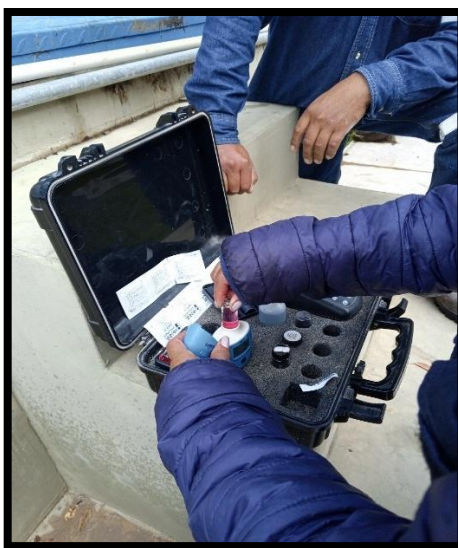
Figura 18 Medición de la muestra de agua clorada in situ.
