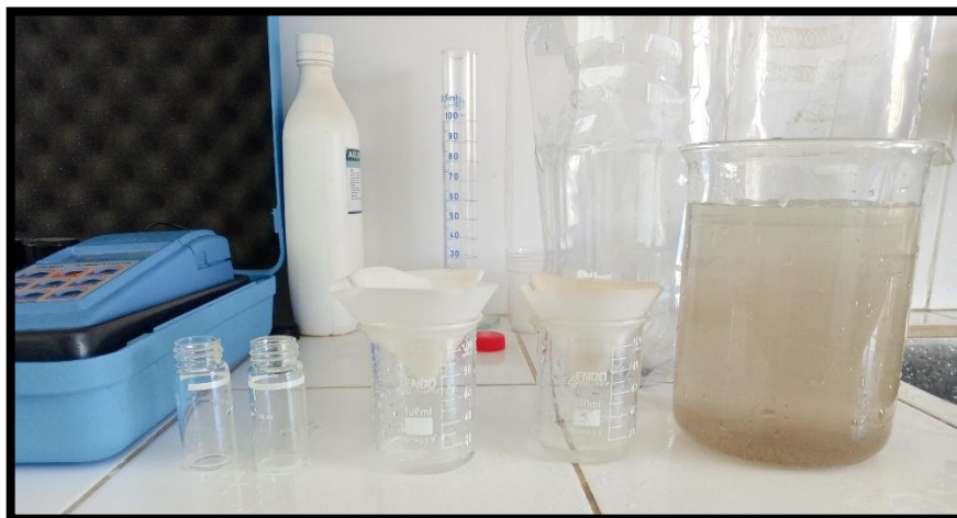
Figura 21 Muestra de agua filtrada en papel filtro.
