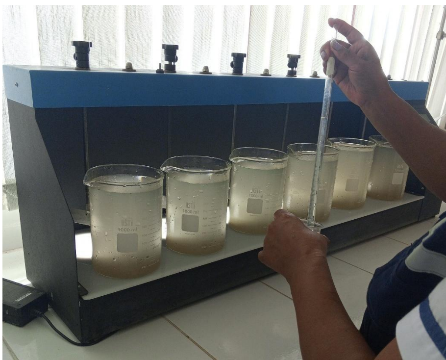
Adición de sulfato de aluminio e hipoclorito de calcio.
