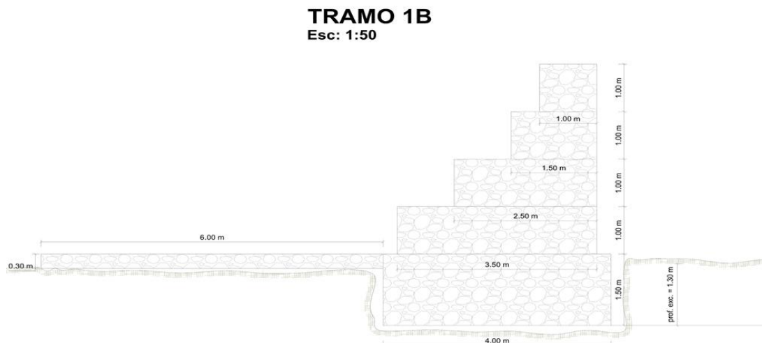
Figura. 6-4. Dimensiones del muro de gavión tramo 1 (1-B).
