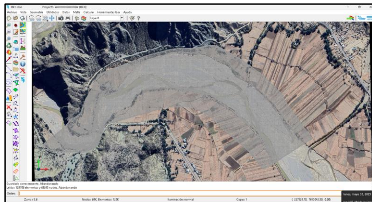
Figura. 5-3. Visualización de la ventana de Iber con la malla de la superficie.
