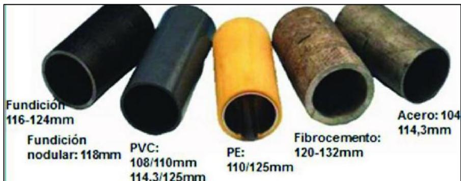
**Figura 2.4.1: Tubería de diferentes materiales.**
