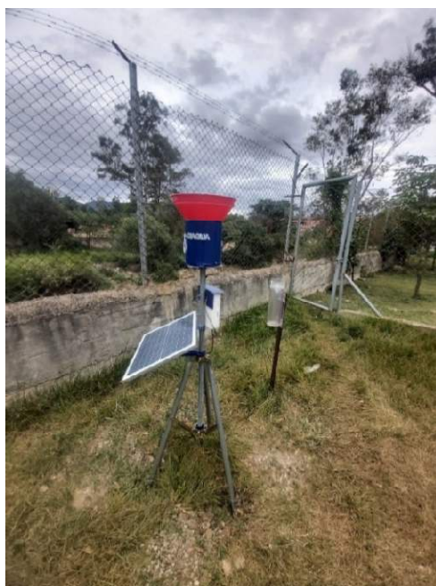
Figura 4.3 Puesta final de pluviómetro CIAGUA-UAJMS y totalizador
