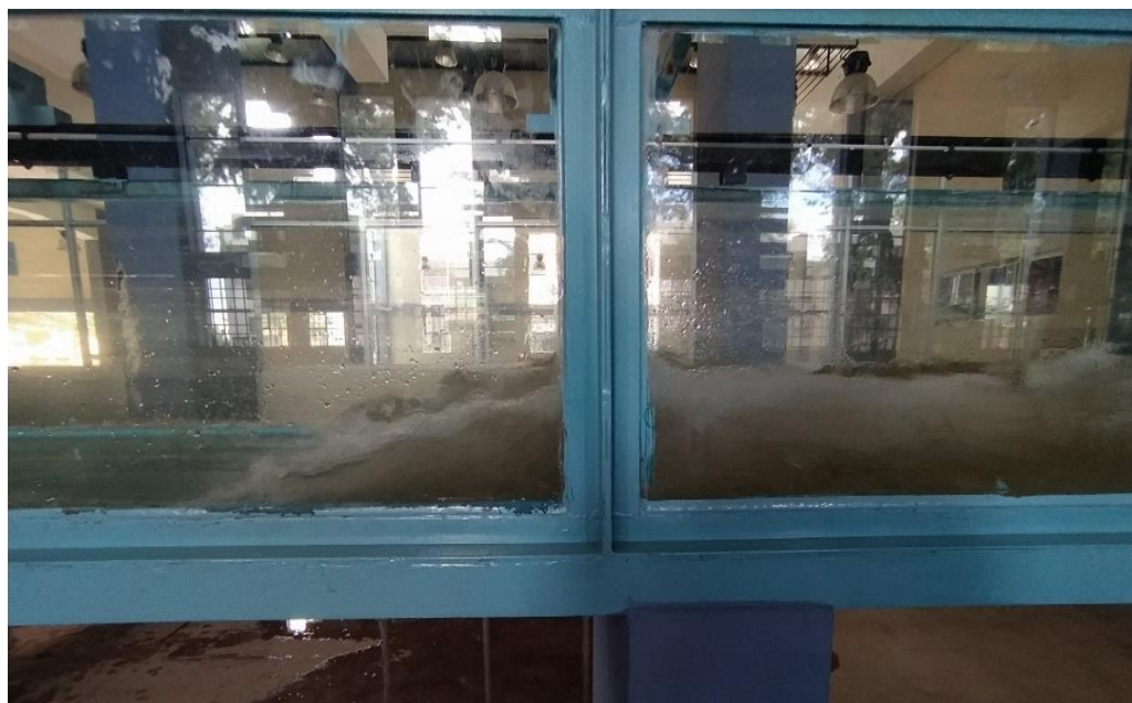
Figura 3: Resalto hidráulico en canal Rehbock.
