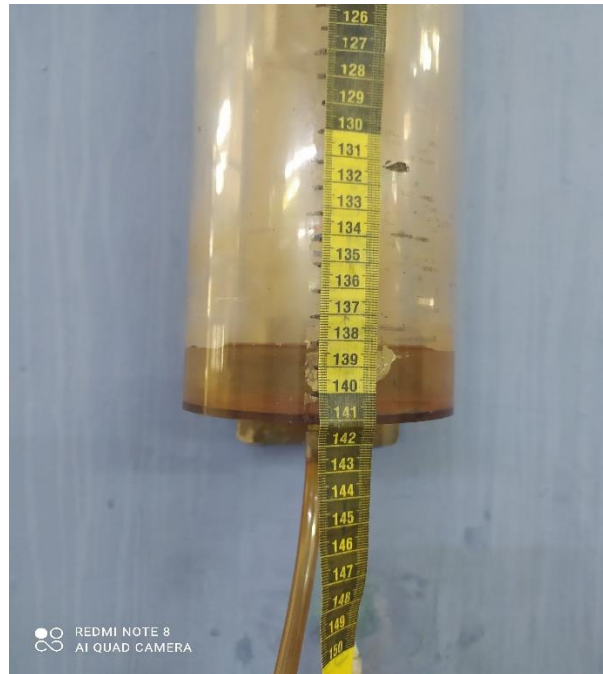
Medición de mira antes del vertedor
