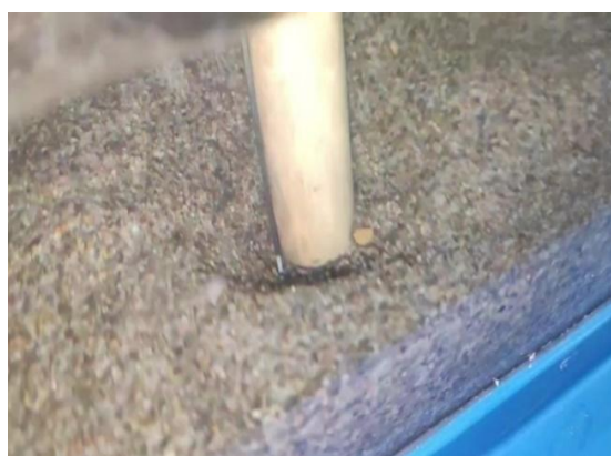
Figura 4.11: Lectura de la profundidad de socavación en la pila.
