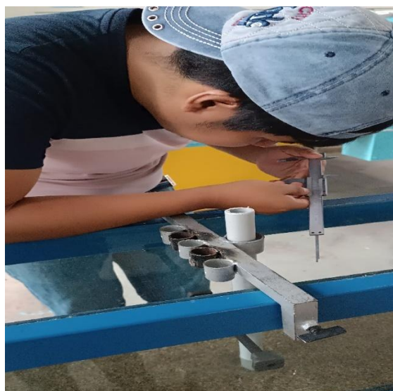
Figura 4.10: Lectura de la profundidad de socavación en la pila.
