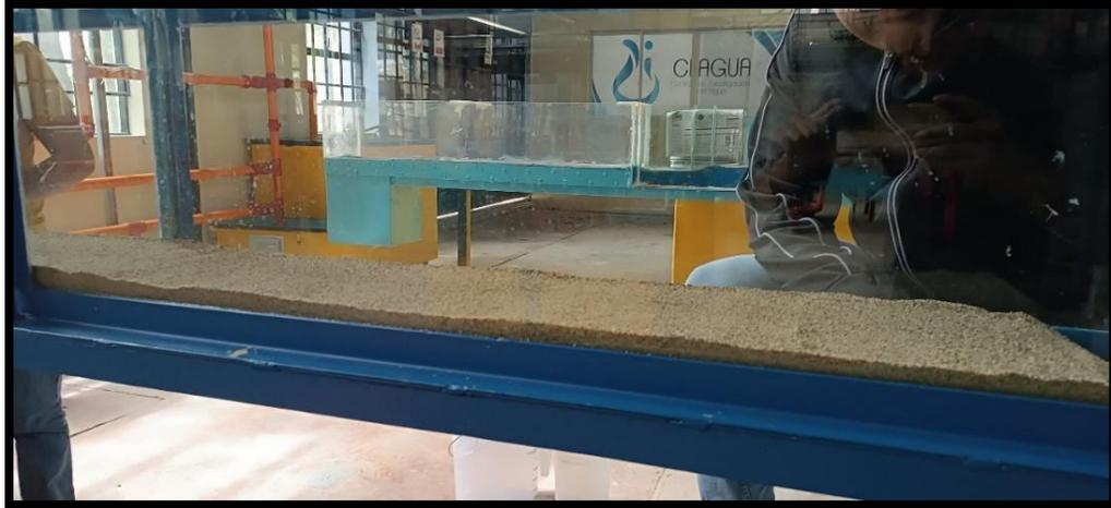
Figura 17: Colocado y nivelado de la arena.
