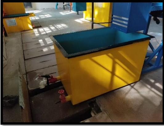
Figura 13: Tanque de aforo.
