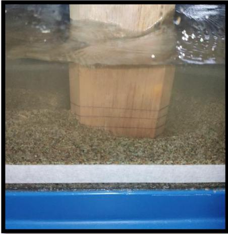
Figura 4: Socavación en agua clara.
