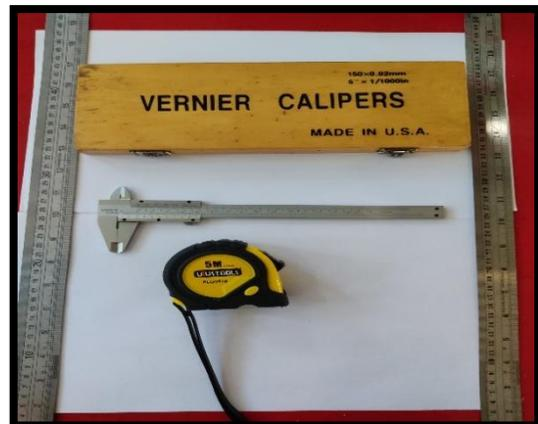
Figura 12: Vernier, regla y flexómetro
