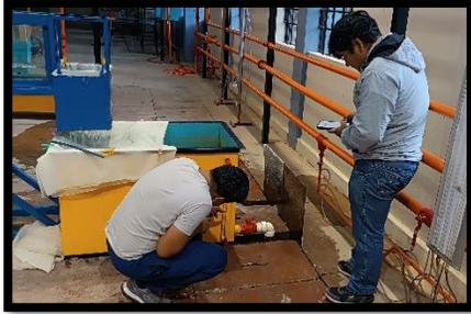
Figura 20: Tanque de aforo.
