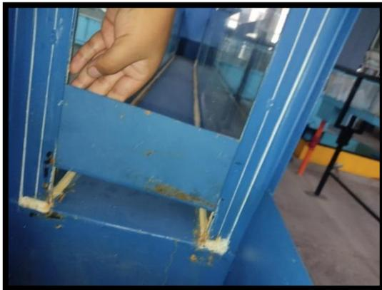
Figura 15: Colocado del vertedero.
