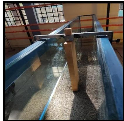
Figura 16: colocado y fijado de la pila.
