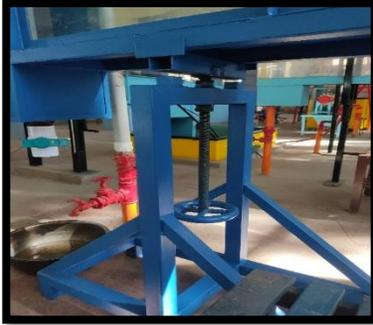
Figura 18: Manivela para cambio de pendiente.
