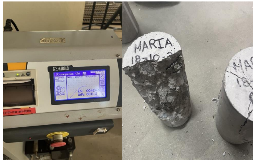
Figura 3.23. Rotura de probetas patrón
