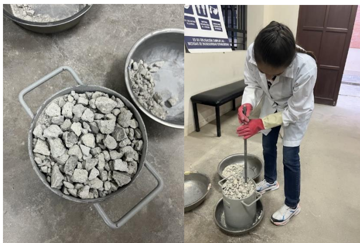
Figura 3.17. Ensayo de peso unitario del concreto reciclado
