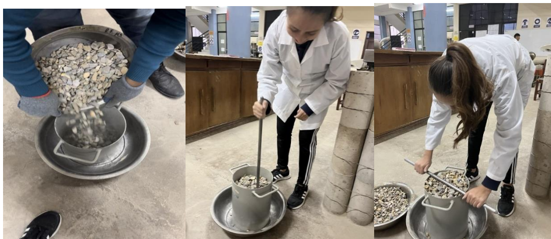
Figura 3.15. Ensayo de peso unitario del agregado grueso
