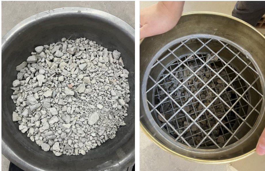
Figura 3.11. Tamizado del concreto reciclado triturado
