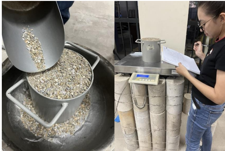
Figura 3.16. Ensayo de peso unitario del agregado fino
