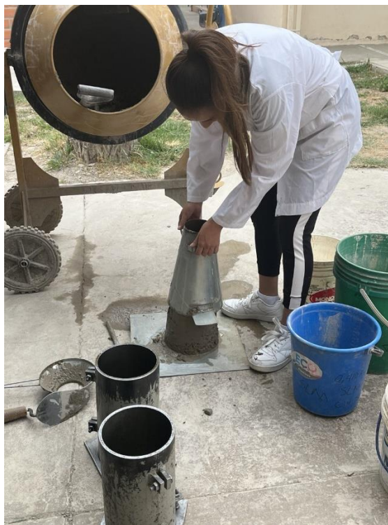
Figura 3.21. Retiro del cono para medir el asentamiento
