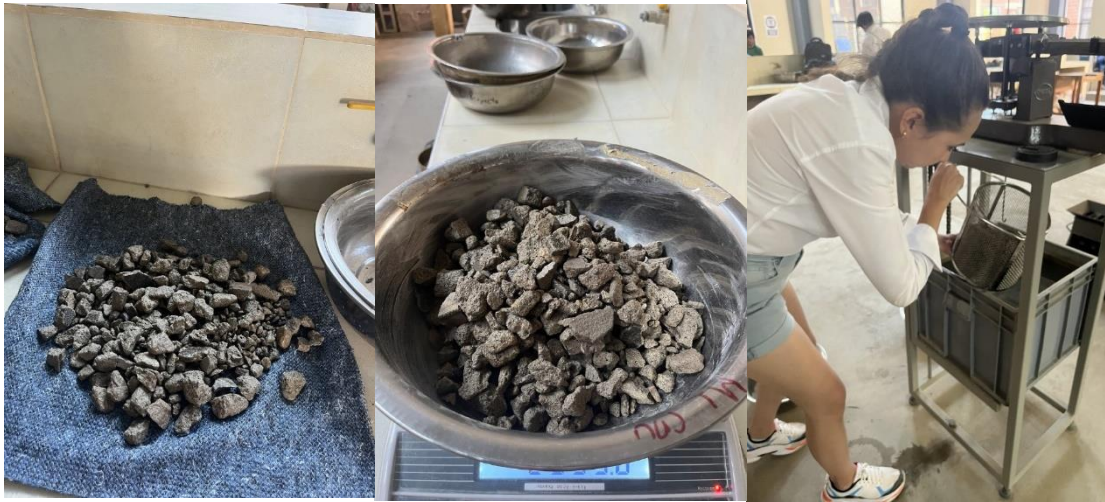
Figura 3.14. Ensayo de peso específico del concreto reciclado
