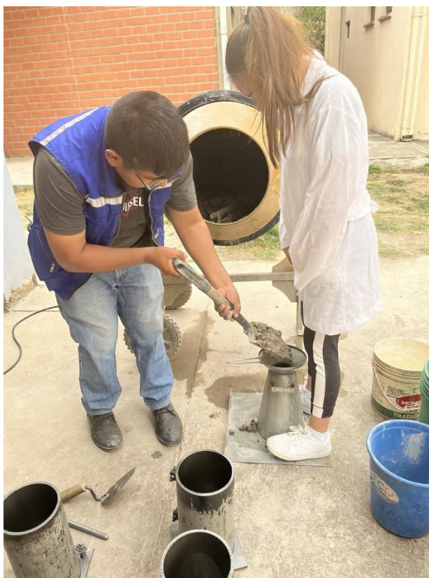
Figura 3.20. Introducción de la mezcla al cono
