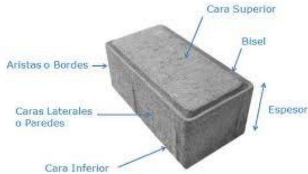
Figura 2.11. Partes de un adoquín tipo
