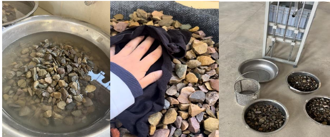
Figura 3.12. Ensayo de peso específico del agregado grueso
