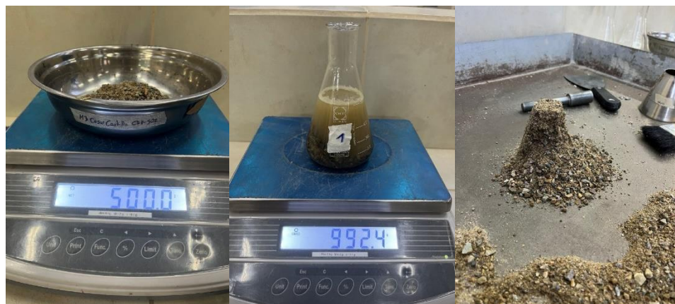
Figura 3.13. Ensayo de peso específico del agregado fino
