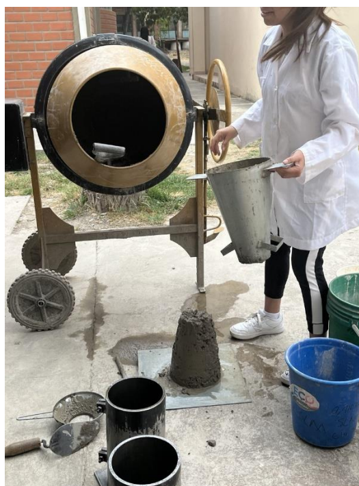
Figura 3.19. Ensayo del cono de Abrams
