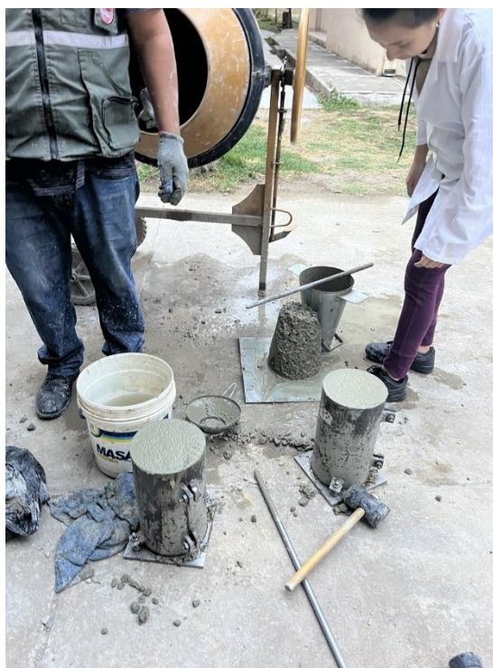
Figura 3.22. Medición del asentamiento del hormigón
