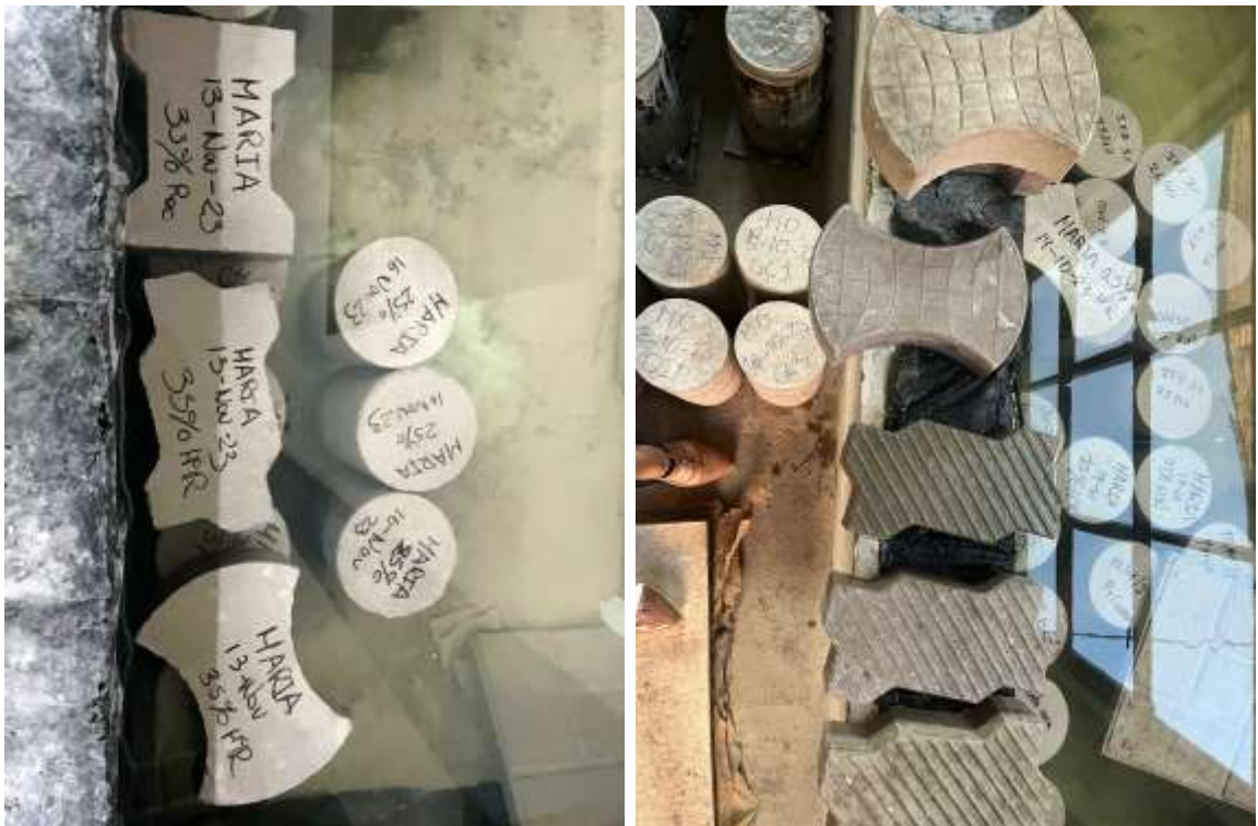
Probetas y adoquines curando, sumergidos en agua.
