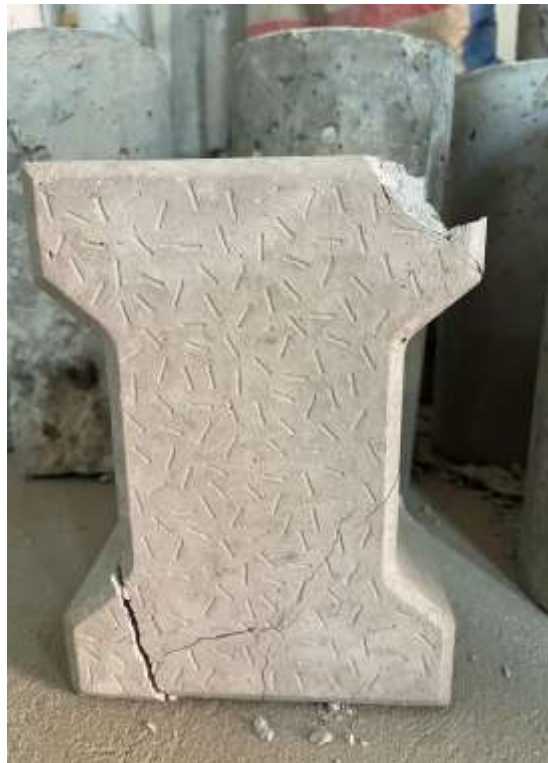
Rotura de adoquín M2
