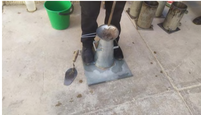
Figura3.45 Ensayo de Asentamiento con cono de Abrams
