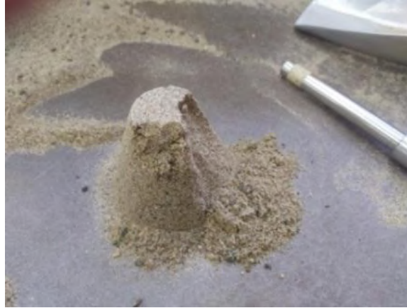
Figura 3.37 Ensayo de prueba con arena seca superficialmente
