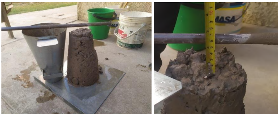
Figura 3.46 Medición del asentamiento
