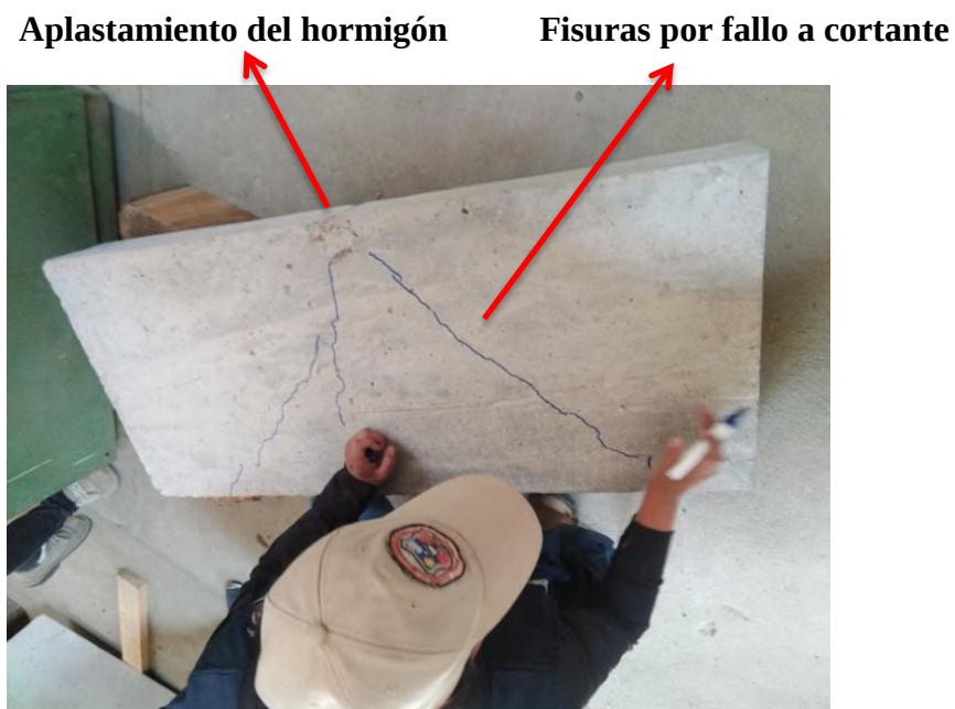
Figura 4.19 Fisuras por fallo a cortante
