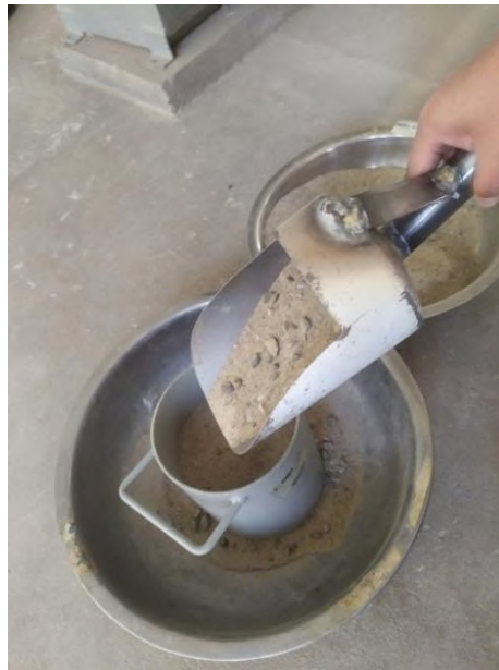
Figura 3.19 Llenado de arena hasta la tercera parte
