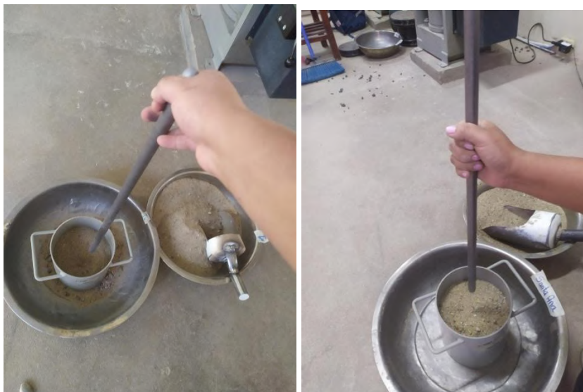
Figura 3.20 Apisonamiento con varilla de 5/8" de diámetro y 60 cm de largo
