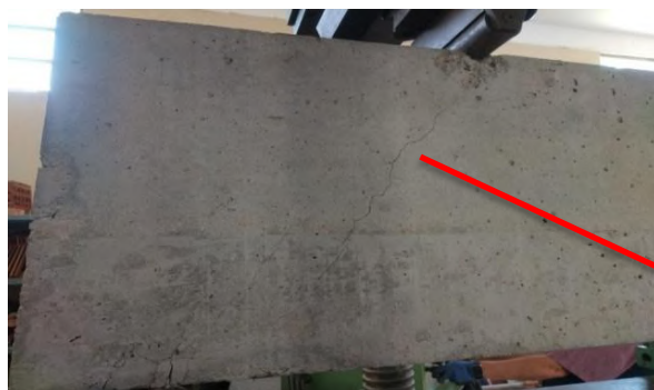
Figura 4.25 Fallo por cortante
