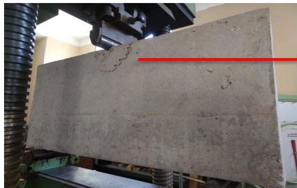
Figura 4.24 Fallo a compresión en cabeza superior de la viga
