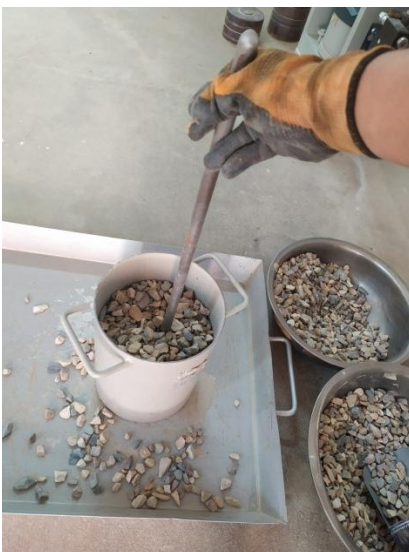
Figura 3.17 Apisonamiento con varilla de 5/8" de diámetro y 60 cm de largo
