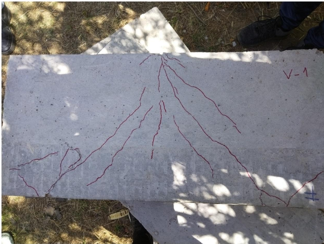
Figura 4.28 Viga sometida a ensayo de flexión
