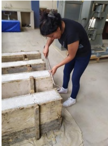
Figura 3.60 Desencofrado de vigas
