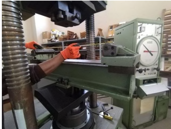
Figura 3.71 Instalación de rodillo de apoyo
