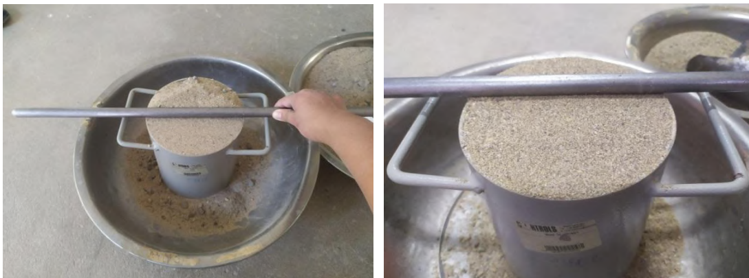
Figura 3.22 Enrasado para deshacerse de la arena que excede
