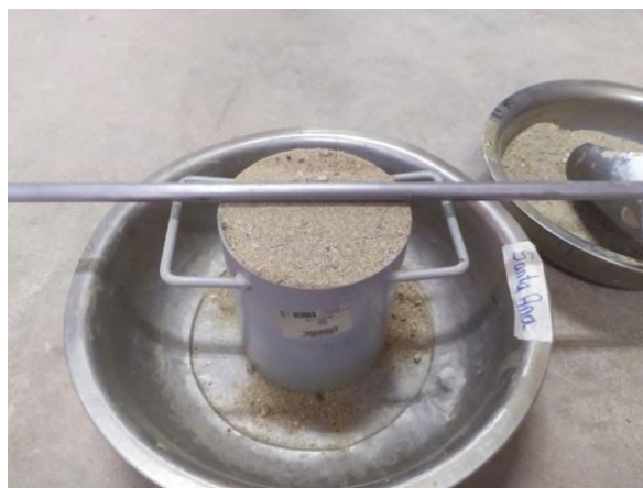
Figura 3.25 Enrasado para eliminar el exceso de arena
