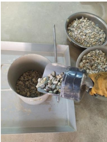
Figura 3.16 Vaciado de la grava en caída libre
