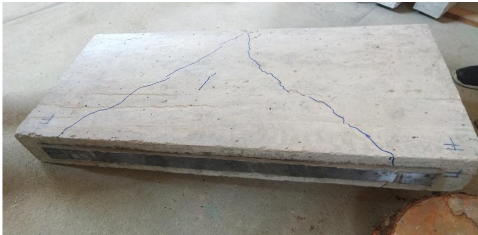
Figura 4.22 Fisuras por fallo a cortante
