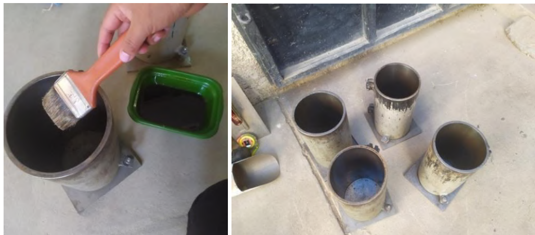
Figura 3.42 Preparación de los moldes
