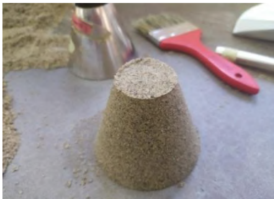
Figura 3.36 Ensayo de prueba para ver si está seco superficialmente
