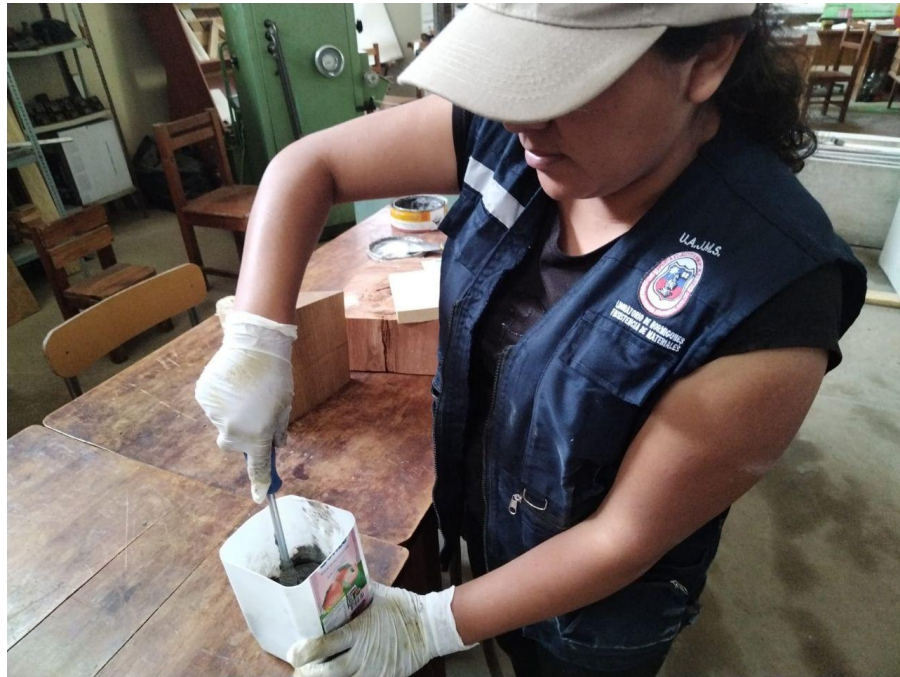
Pegado de las Platinas de fibra de Carbono
