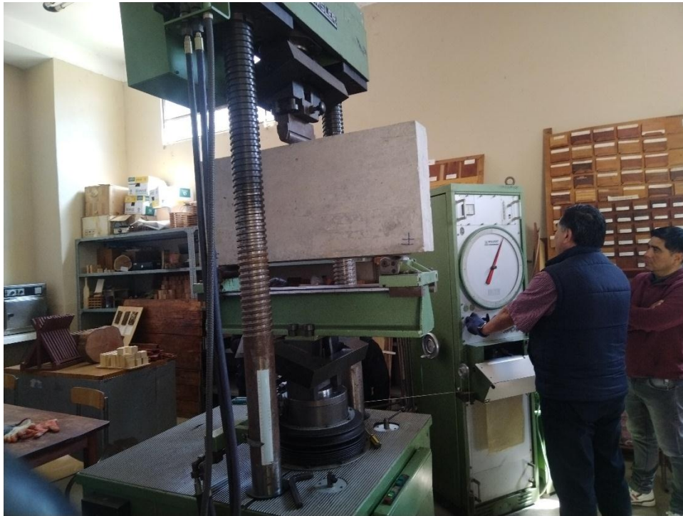
Lectura de la deformación en el indicador dial
