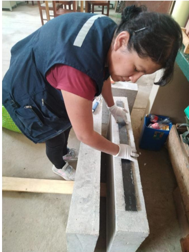
Colocación de la viga sobre el dispositivo de Flexión
