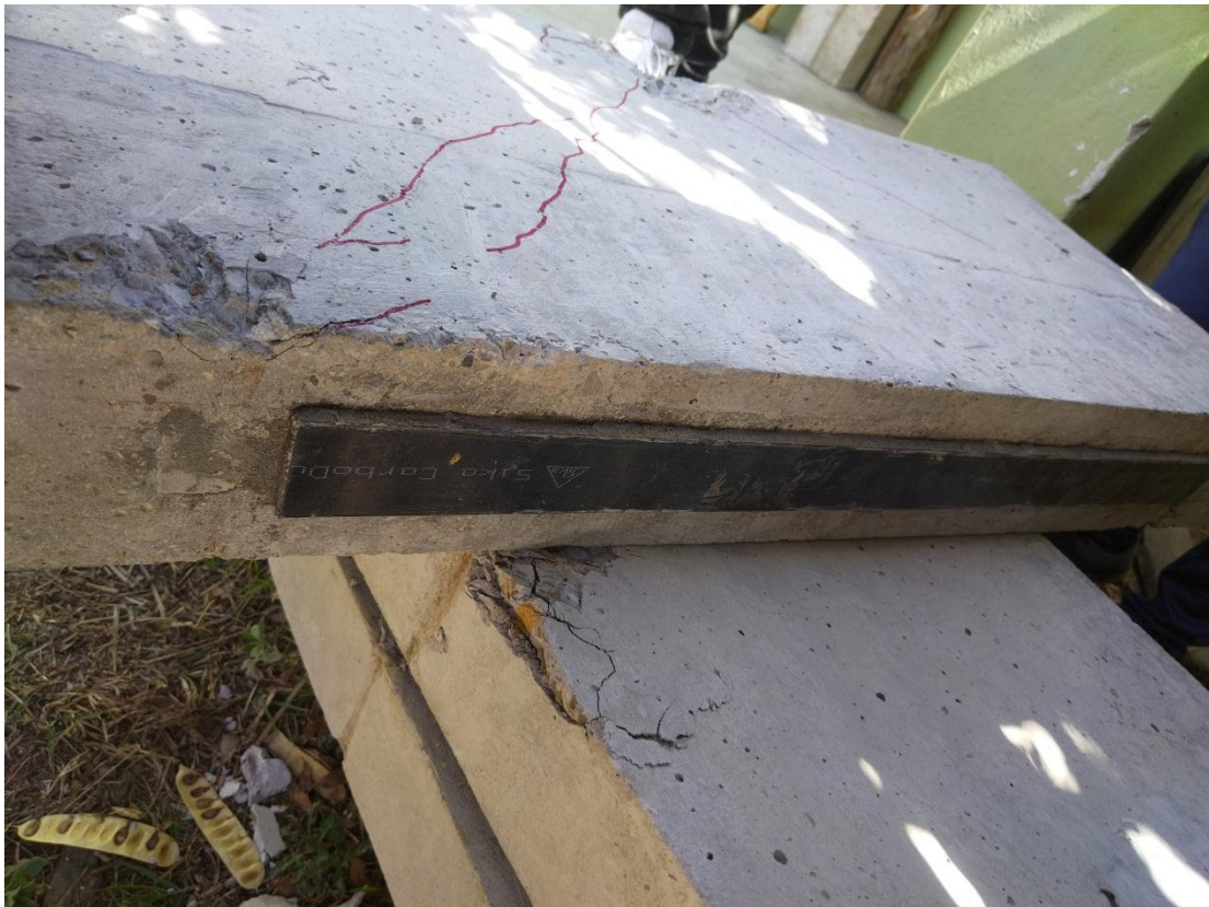
Fisuras en la Viga con Refuerzo
