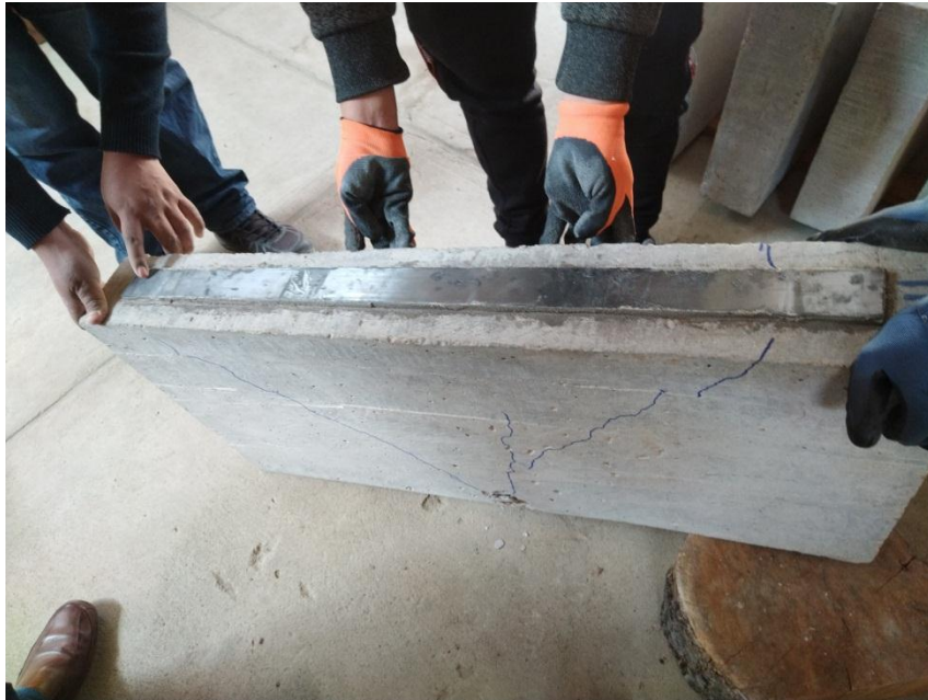
Fisuras en la Viga con Refuerzo
