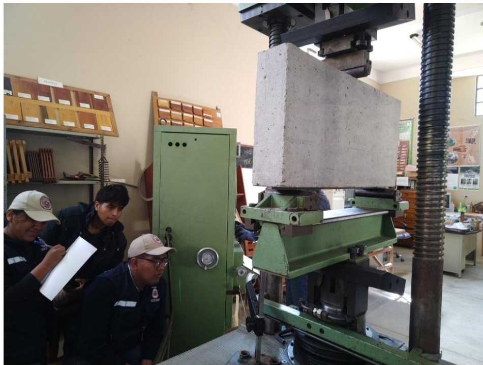
Lectura de la deformación en el indicador dial
