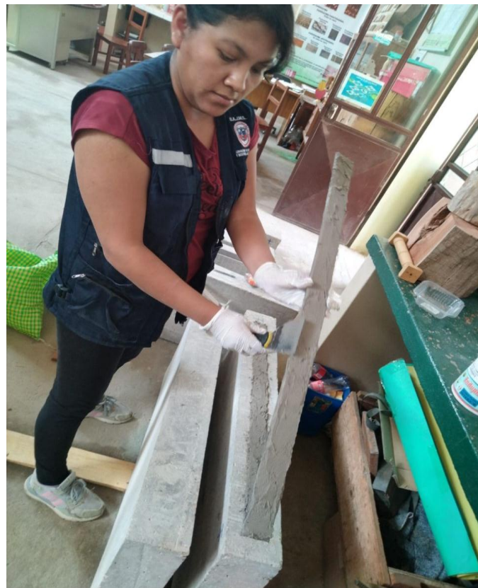
Pegado de las Platinas de fibra de Carbono
