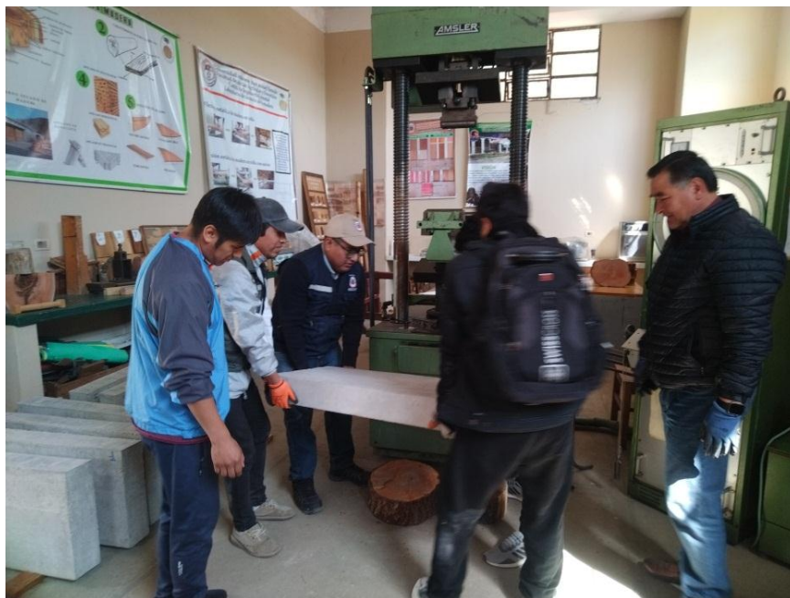
Colocación de la viga sobre el dispositivo de Flexión
