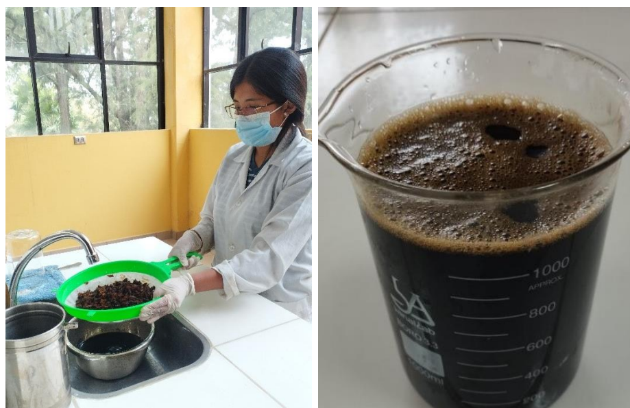
Figura II-9: Ecurrido de la pulpa cruda y licor negro separado
