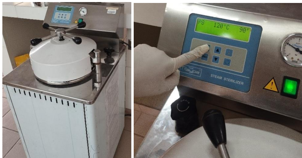
Figura II-8: Puesta en marcha del autoclave
