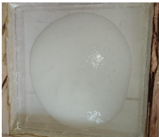
Figura II-14: Pulpa de celulosa ingresando al molde
