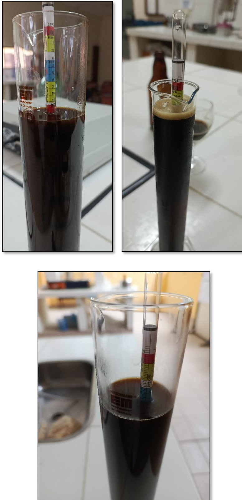
Fotografía IV-30 Medición de la densidad
