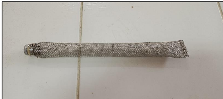
Fotografía IV-5 Filtro de olla maceradora
