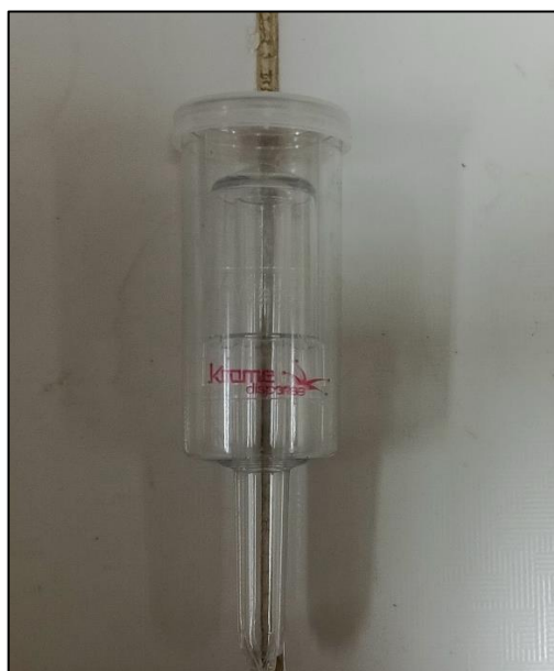
Fotografía IV-19 Trampa de aire
