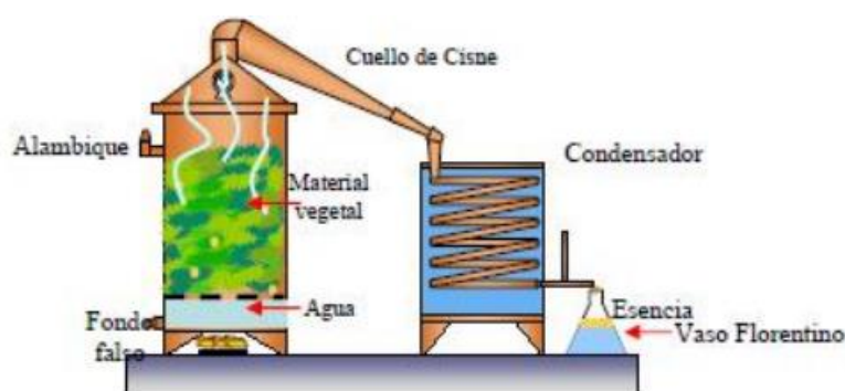
FIGURA 3-7. TANQUE EXTRACTOR CON CÁMARA DE AGUA
