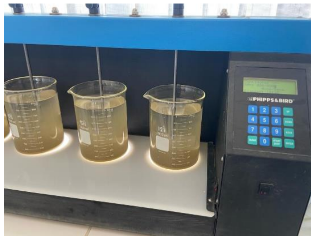
Figura 2-14. Formación de flocs y sedimentación
