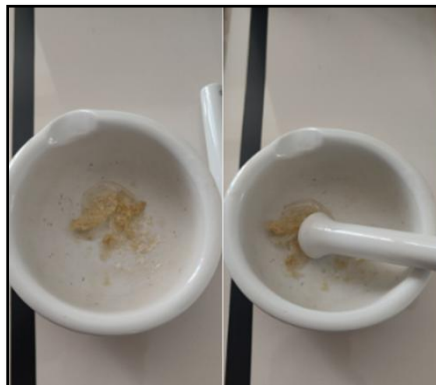
Figura III-21 Molienda de la pectina
