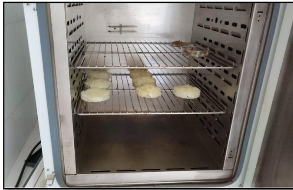
Figura III-20 Secado de la pectina
