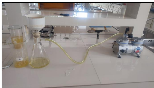
Figura III-15 Filtrado al vacío de la solución hidrolizada
