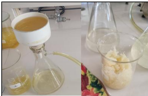
Figura III-18 Filtrado y lavado de la pectina obtenida
