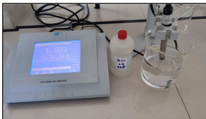
Figura III-13 Hidrólisis Ácida ajustando el pH
