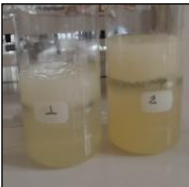
Figura III-17 Precipitación de pectina con etanol
