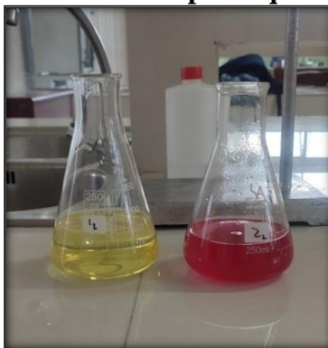
Figura III-24 Determinación del peso equivalente y acidez libre
