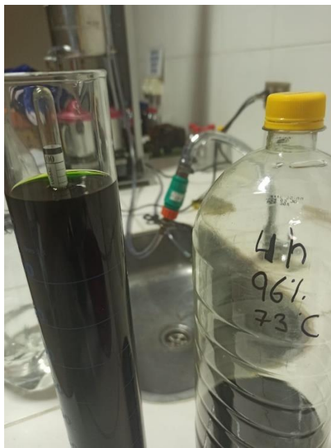
FIGURA II-8: Medición con el alcoholímetro del extracto obtenido
