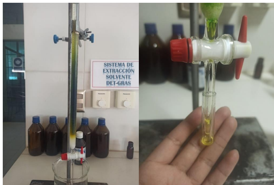
FIGURA II-19: Cromatografía en columna para la separación de beta caroteno de la extracción concentrada obtenida
