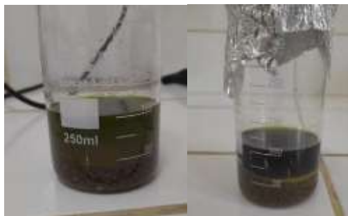
Fig. 2- 17 Solución preparada al 90% de etanol con partículas de 0,25 mm y 0,50 mm
