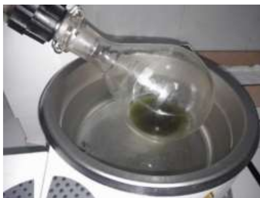
Fig. 2- 20 El extracto tánico en el rota-vapor
