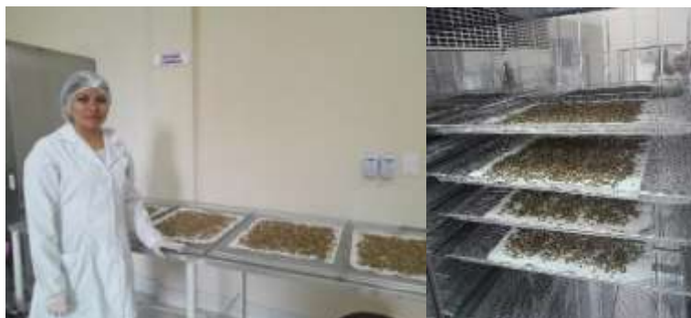
Fig. 2- 9 Cáscara de banano verde cortado en la secadora de bandejas
