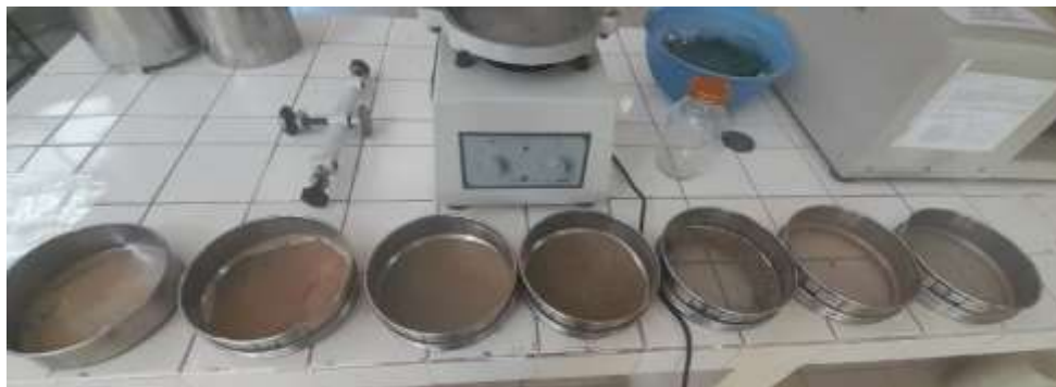
Fig. 2- 12 Cáscara de plátano tamizado en las diferentes mallas
