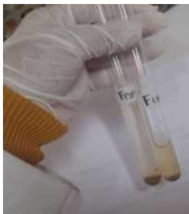
Fig. 2- 29 Formación de precipitado con acetato de plomo-ácido acético
