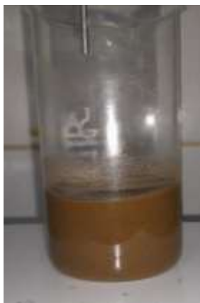
Fig. 2- 13 Solución del 70% preparada con partículas de 0,063 mm
