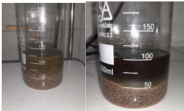
Fig. 2- 15 Solución preparada con 50% de etanol y partículas de 0,25 mm y 0,50 mm
