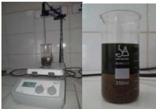
Fig. 2- 18 Extracción de taninos con el solvente durante la agitación, el extracto tánico
