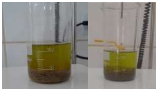
Fig. 2- 16 Solución preparada con 70% de etanol, y partículas de 0,25 mm y 0,50 mm
