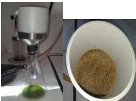
Fig. 2- 19 Filtración del extracto tánico
