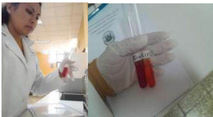
Fig. 2- 27 Prueba de coloración con Ácido Clorhídrico
