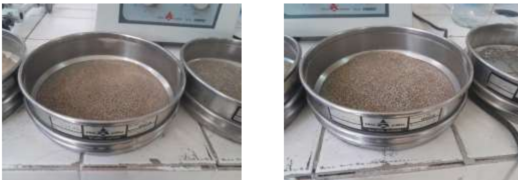
Registro fotográfico del tamizado partículas de 0,25 mm y 0,50 mm
