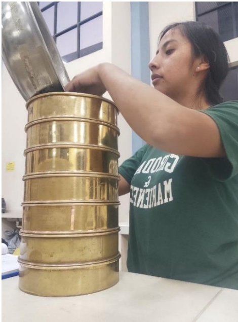
Figura 17 Colocado de agregado en el juego de tamices
