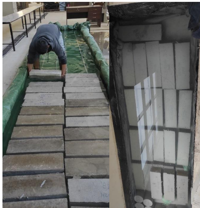
Figura 56 Curado de vigas prismáticas: Para el curado de las vigas prismáticas, se emplearon dos piscinas
