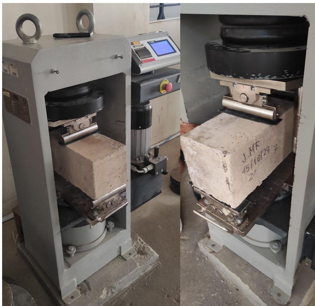
Figura 57 Montaje de probeta prismática para ensayo de flexión
