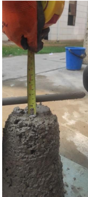
Figura 36 Prueba de asentamiento
