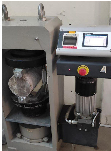
Figura 45 Resistencia Tracción Indirecta
