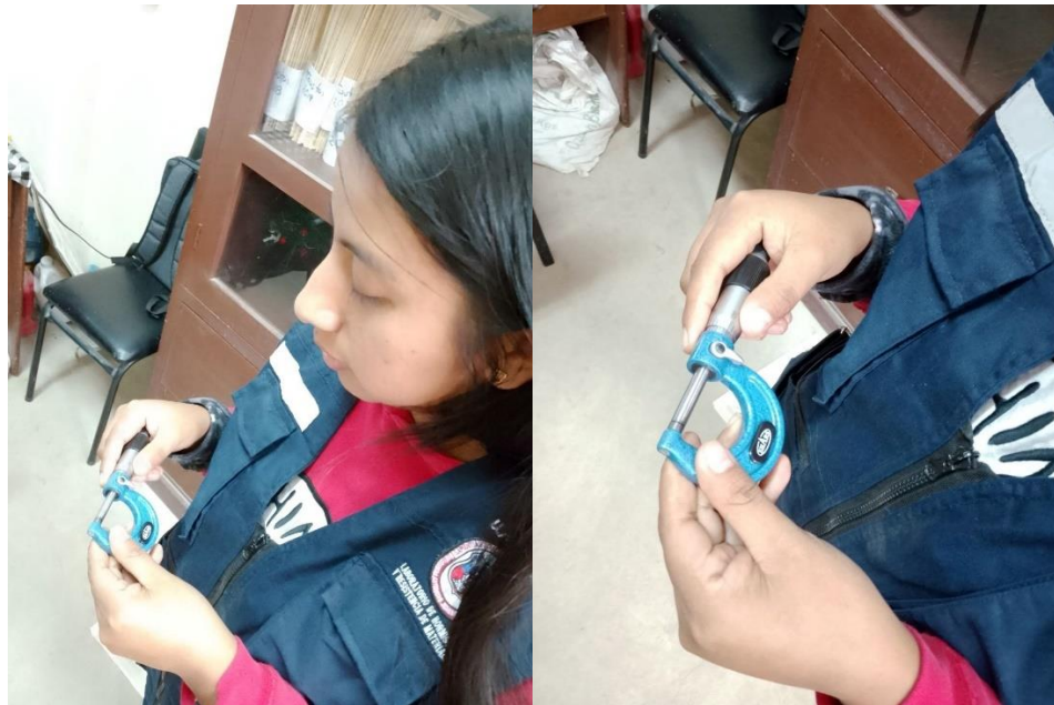
Figura 8 Determinación del diámetro de fibras utilizando un micrómetro
