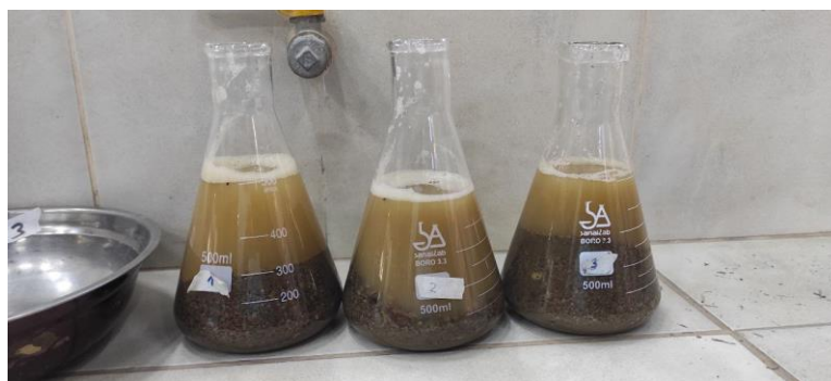
Figura 28 Peso específico de agregado fino
