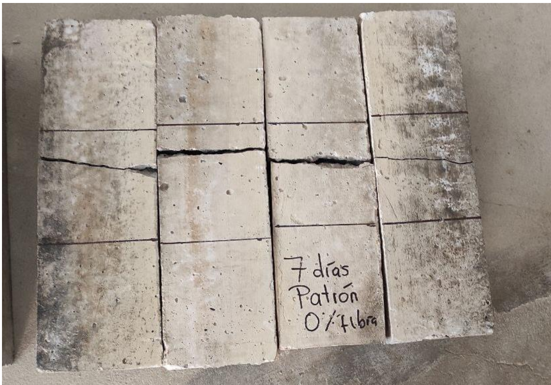
Figura 61 Vigas después de la rotura de vigas patrón 0% de fibra a los 7 días
