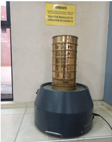
Figura 18 Montaje del juego de tamices en el tamizador para el análisis granulométrico
