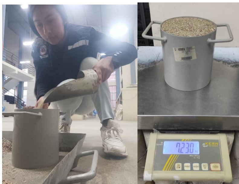
Figura 31 Peso unitario agregado fino
