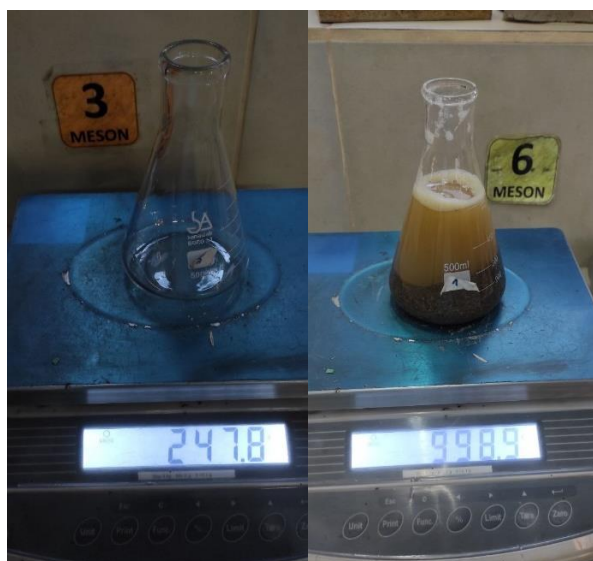
Figura 27 Peso específico de agregado fino
