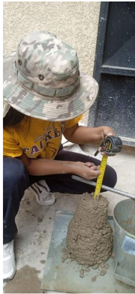
Figura 35 Prueba de asentamiento
