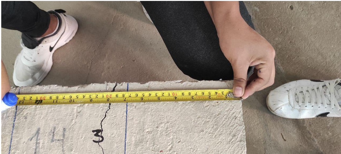
Figura 60 Falla de viga en el tercio central
