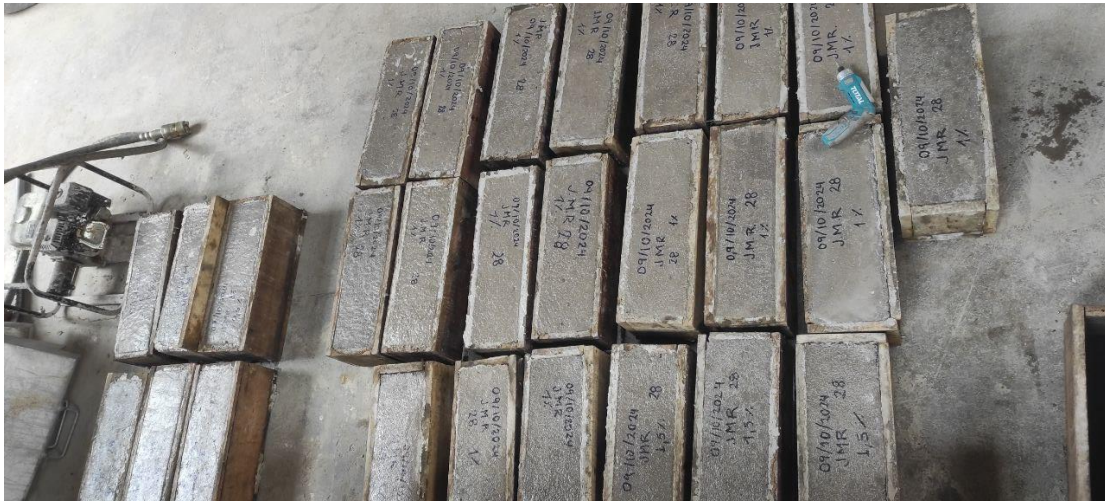
Figura 55 Desmolde de vigas prismáticas e identificación
