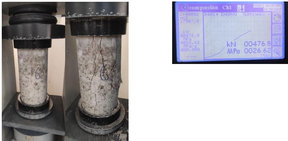
Figura 44 Verificación de la Dosificación de Hormigón H-25 mediante Ensayo de Compresión
