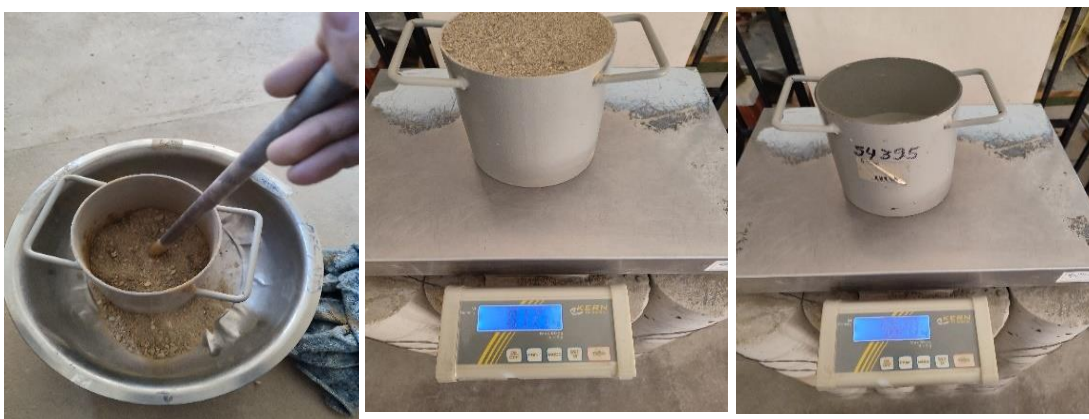
FIGURA 3.2.7-1: DETERMINACIÓN DEL PESO UNITARIO DEL AGREGADO FINO
