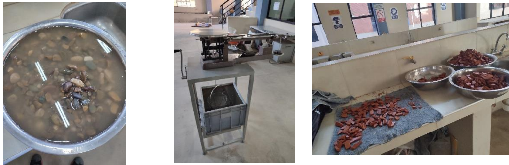
FIGURA 3.2.4-1: DETERMINACIÓN DEL PESO ESPECIFICO Y ABSORCIÓN DEL AGREGADO GRUESO (GRAVA Y LADRILLO).
