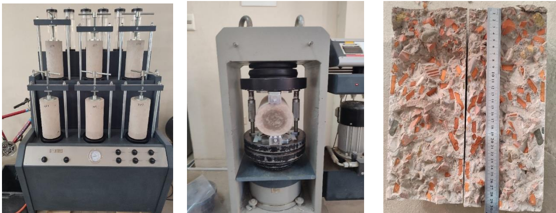
FIGURA 3.2.13: ENSAYO PENETRACIÓN DE AGUA BAJO PRESIÓN
