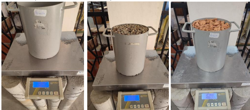
FIGURA 3.2.6-1: DETERMINACIÓN DEL PESO UNITARIO DEL AGREGADO GRUESO (GRAVA Y LADRILLO).
