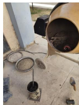
FIGURA 3.2.9-5: VACIADO Y REALIZACIÓN DE PROBETAS
