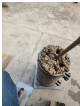
FIGURA 3.2.9-5: VACIADO Y REALIZACIÓN DE PROBETAS
