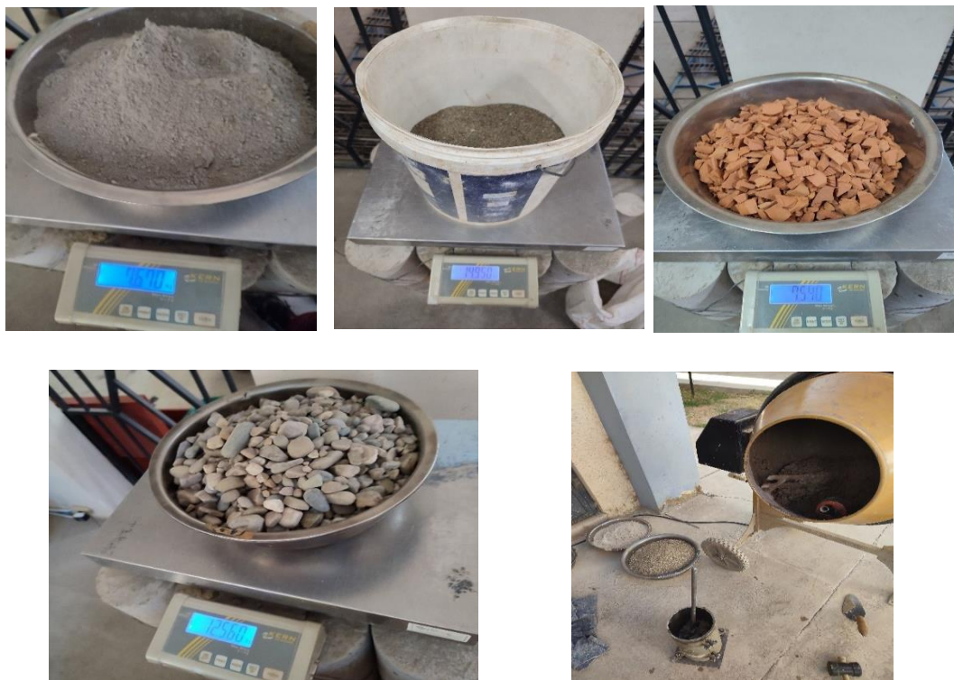
FIGURA 3.2.9-1: PESADO DE MATERIALES PARA LA ELABORACION DE LAS MEZCLAS DE HORMIGÓN.
