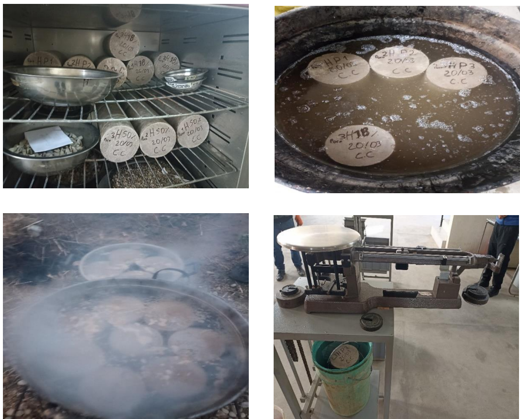
FIGURA 3.2.15: ENSAYO DETERMINACIÓN DE LA DENSIDAD, LA ABSORCIÓN DE AGUA Y LOS VACÍOS EN EL CONCRETO ENDURECIDO.
