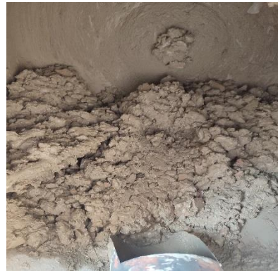
FIGURA 3.2.9-2 MEZCLADO DE LAS MUESTRAS DE HORMIGÓN
