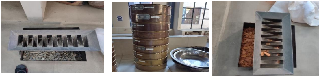
FIGURA 3.2.3-1: ANÁLISIS GRANULOMETRICO DEL AGREGADO GRUESO (GRAVA Y LADRILLO)
