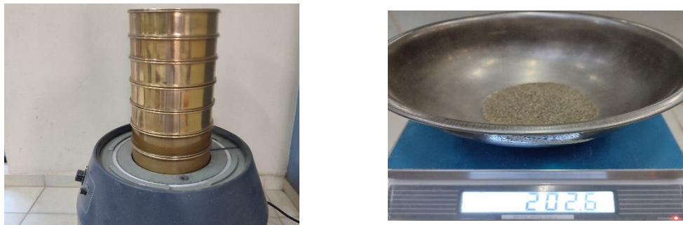
FIGURA 3.2.3-2: ANÁLISIS GRANULOMETRICO DEL AGREGADO FINO.
