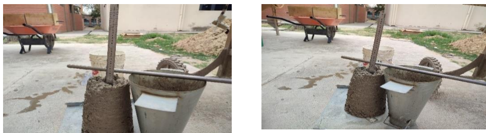
FIGURA 3.2.9-3: ENSAYO DE ASENTAMIENTO A LAS MEZCLAS REALIZADAS.
