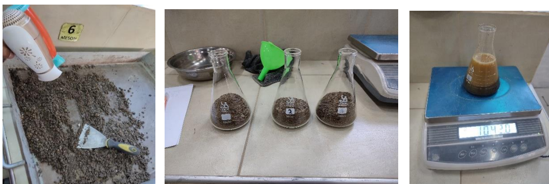
FIGURA 3.2.5-1: DETERMINACIÓN DEL PESO ESPECÍFICO Y ABSORCIÓN DEL AGREGADO FINO.
