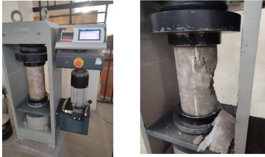
FIGURA 3.2.10-1: ENSAYOS DE ROTURA DE PROBETAS
