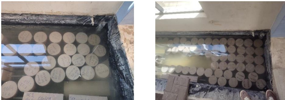
FIGURA 3.2.9-6: CURADO DE LAS PROBETAS DE PRUEBA
