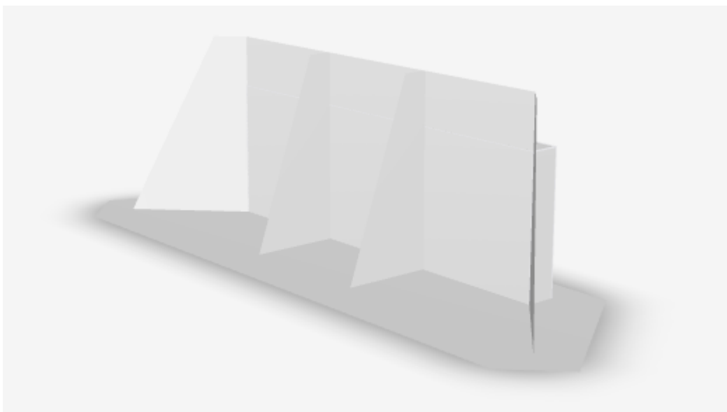
Figura 4.1. modelación 3D de estribo con contra fuerte
