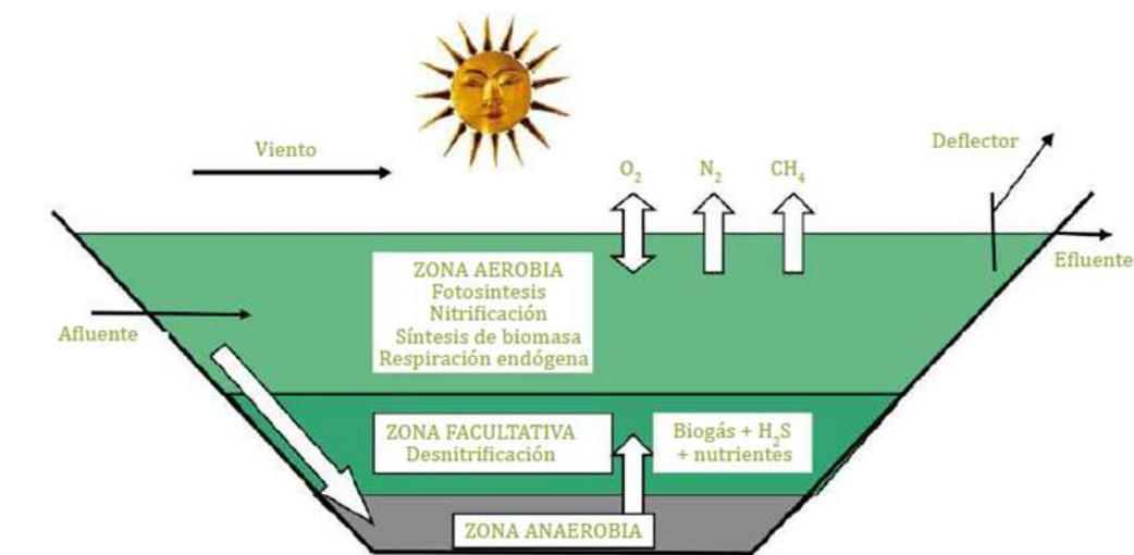
Figura 2. 10 Esquema de una laguna facultativa.
