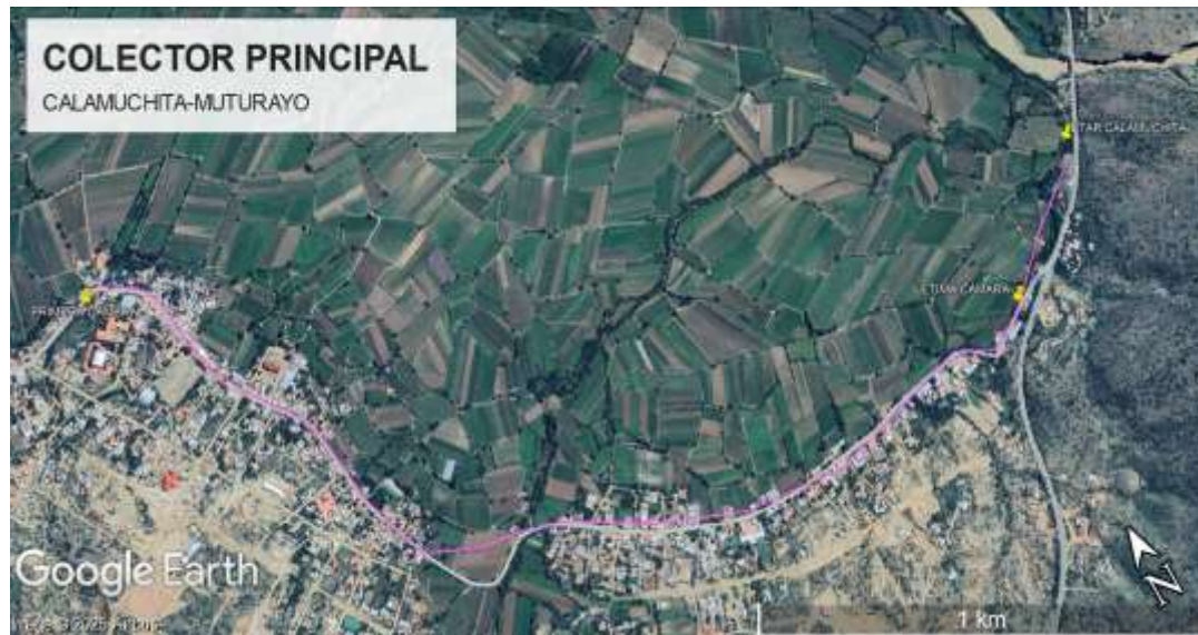
Figura 5. 6 Emisario de la red de saneamiento en Calamuchita.
