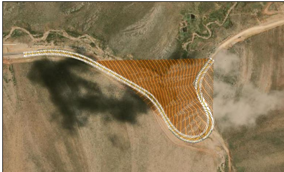
Figura 19: Vista en planta de todo el tramo en AutoCAD con mapa aéreo
