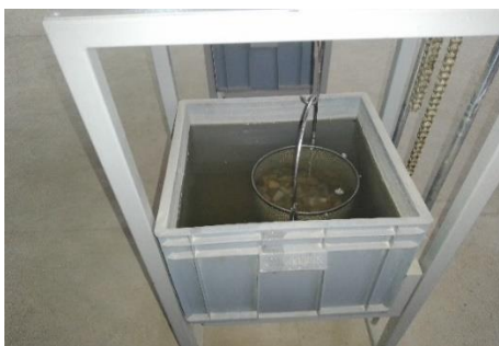
Figura 3.8. Peso del material pétreo sumergido
