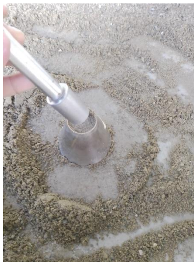
Figura 3.12. Muestra colocada en molde cónico.
