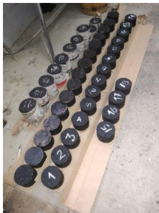
Figura 3.43. Briquetas con C.A. con diferentes porcentajes de polímero
