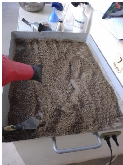
Figura 3.11. Eliminación del exceso de agua en la muestra.
