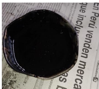
Figura 3.39. Cemento asfáltico mezclado con E.V.A.
