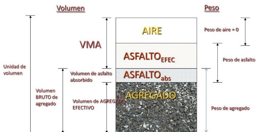
Figura 2.7. Representación de volumen en una briqueta de mezcla asfáltica.
