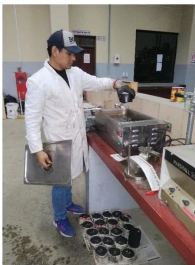
Figura 3.33. Briquea preparada para la rotura.
