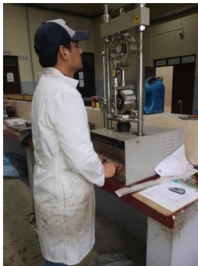
Figura 3.34. Momento de la rotura de la briqueta.
