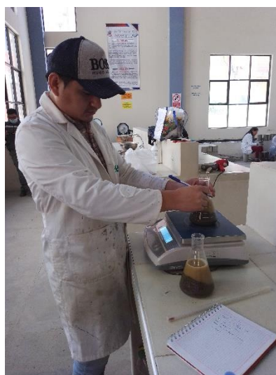
Figura 3.18. Medición de la masa total del matraz con la muestra y agua.
