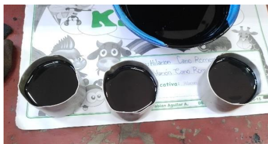
Figura 3.23. Muestras de ensayo antes de ser colocadas al penetrómetro
