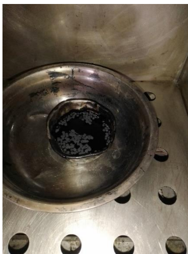
Figura 3.38. Cemento asfáltico mezclado con E.V.A. en el horno a 125 °C.
