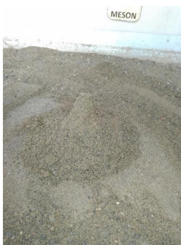
Figura 3.15. Árido alcanzando la condición saturada superficialmente seca
