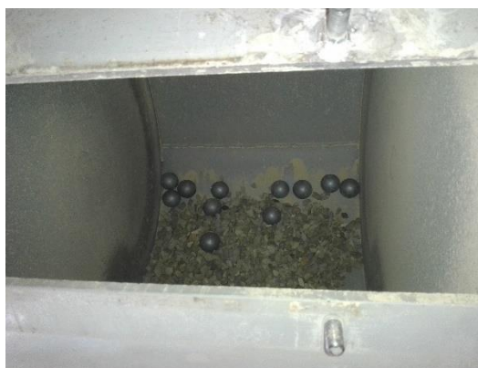
Figura 3.21. Material colocado en la máquina de Los Ángeles.
