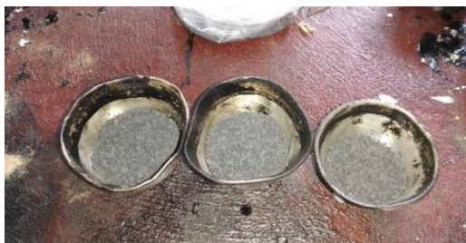
Figura 3.40. Partículas de E.V.A. cortadas en fracciones más pequeñas.
