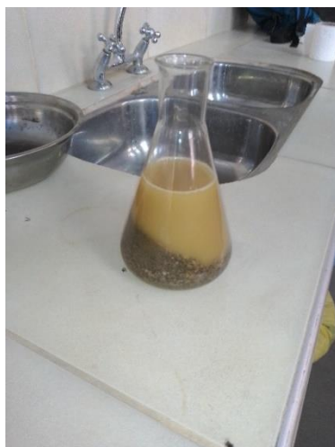
Figura 3.16. Muestra colocada en el matraz con agua a 20 °C
