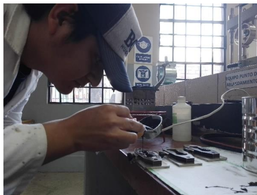
Figura 3.24. Colocado del cemento asfáltico dentro del molde.
