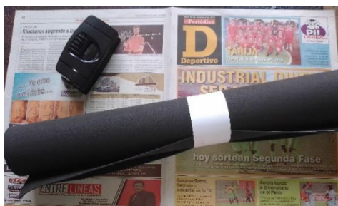
Figura 3.35. Goma E.V.A (Etileno Vinil Acetato) polímero a utilizar.
