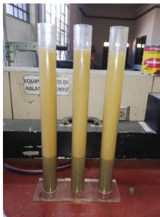
Figura 3.19. Probeta en reposo por un periodo de 10 minutos
