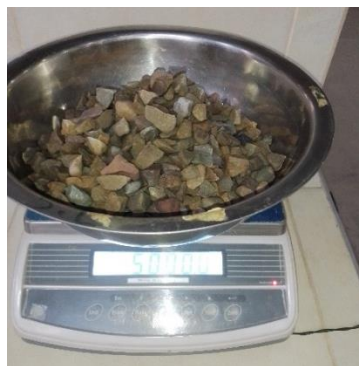
Figura 3.7. Material pesado al aire saturado superficialmente seco
