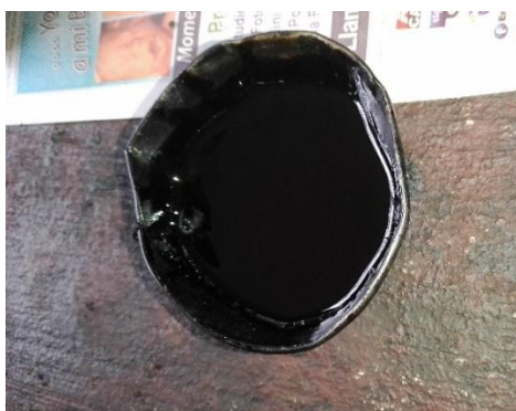
Figura 3.42. Cemento asfáltico modificado con polímero E.V.A.
