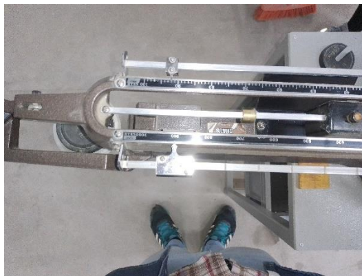
Figura 3.9. Lectura del peso sumergido en agua
