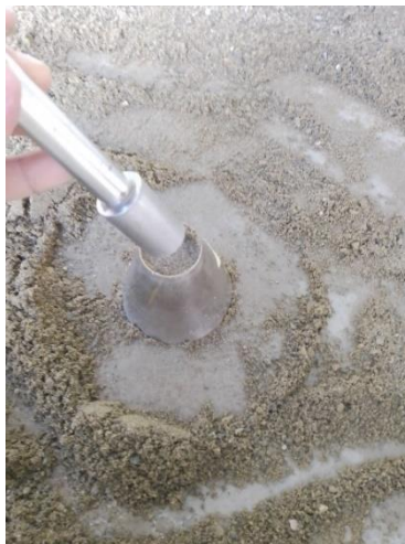
Figura 3.13. Muestra compactada con 25 golpes de pisón sobre la superficie
