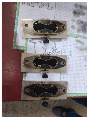
Figura 3.25. Material enfriando a temperatura ambiente.
