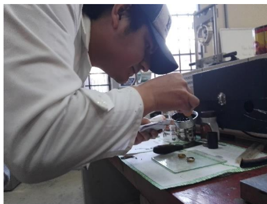
Figura 3.28. Vertido de la muestra caliente dentro de los dos anillos.
