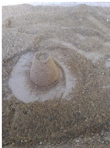
Figura 3.14. Muestra con exceso de humedad
