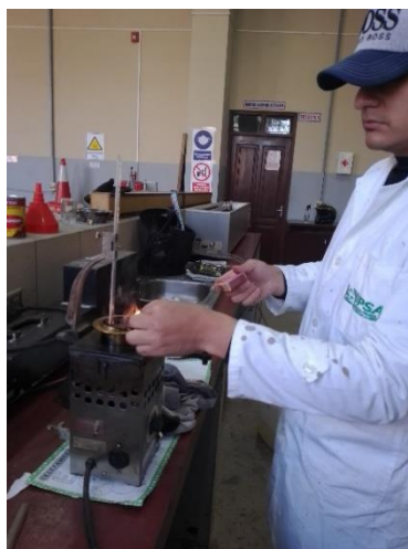
Figura 3.27. Durante el ensayo de punto de inflamación.
