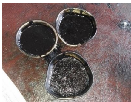
Figura 3.41. Partículas de polímero E.V.A. agregadas al cemento asfáltico caliente.
