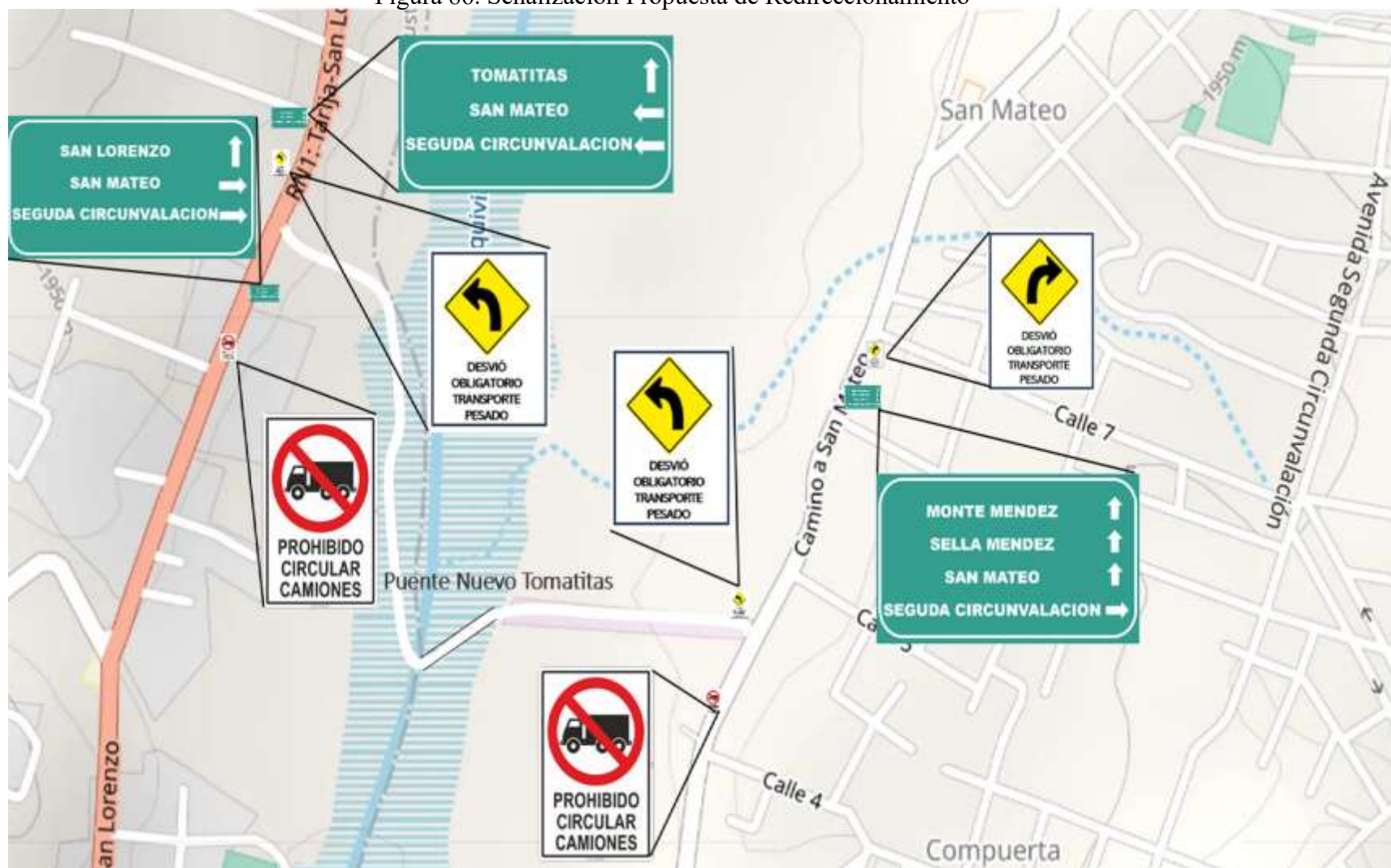
Figura 86. Señalización Propuesta de Redireccionamiento
