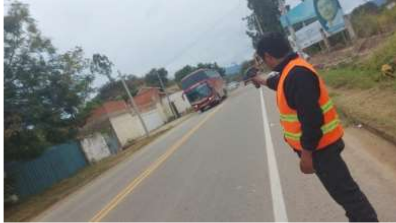
Figura 18. Medición de Velocidades Punta, punto 3 Carretera Tomatitas
