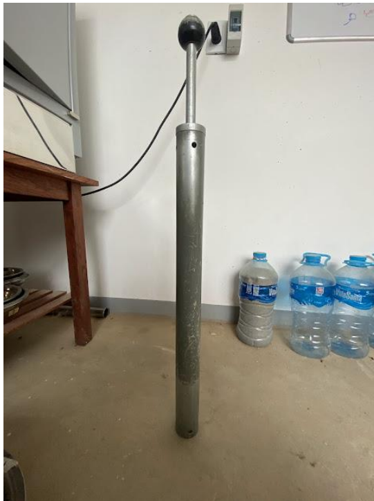
Figura 3.27 Martillo metálico de 4.5 kg y altura de caída de 46 cm
