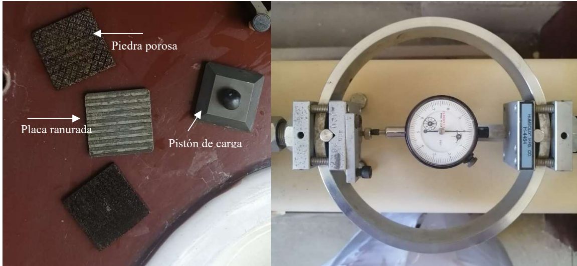
Figura II.7 Pistón de carga, piedras porosas, placa ranurada y anillo de carga
