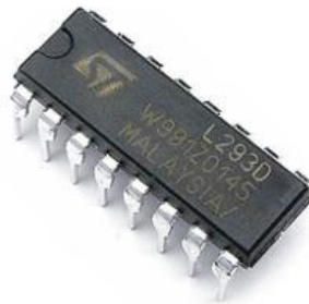
Figura 124 Puente H L293D
