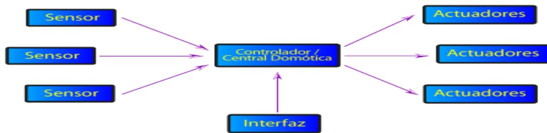
Figura 115 Diagrama de conexión sensor-controlador-actuador
