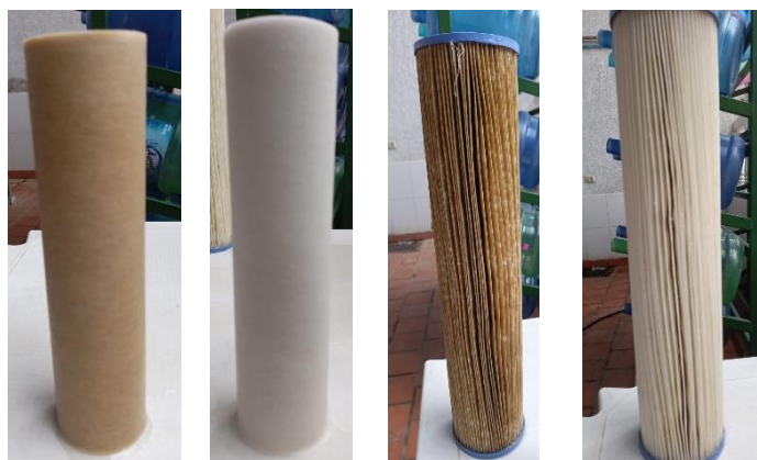
Figura 7. Imágenes de los filtros antes y después de su lavado.
