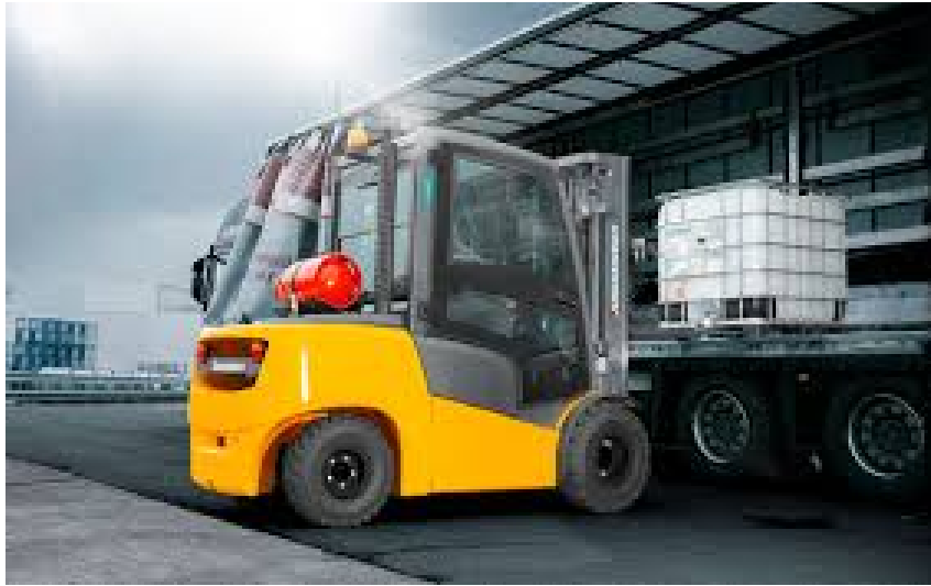
Figura 22.- Montacargas elevando un tanque IBC.
