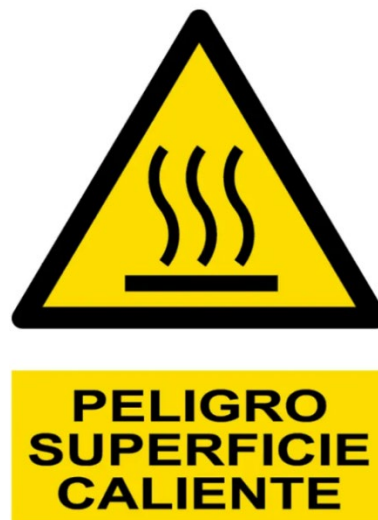
Figura 45.- Señal de advertencia de superficie caliente.
