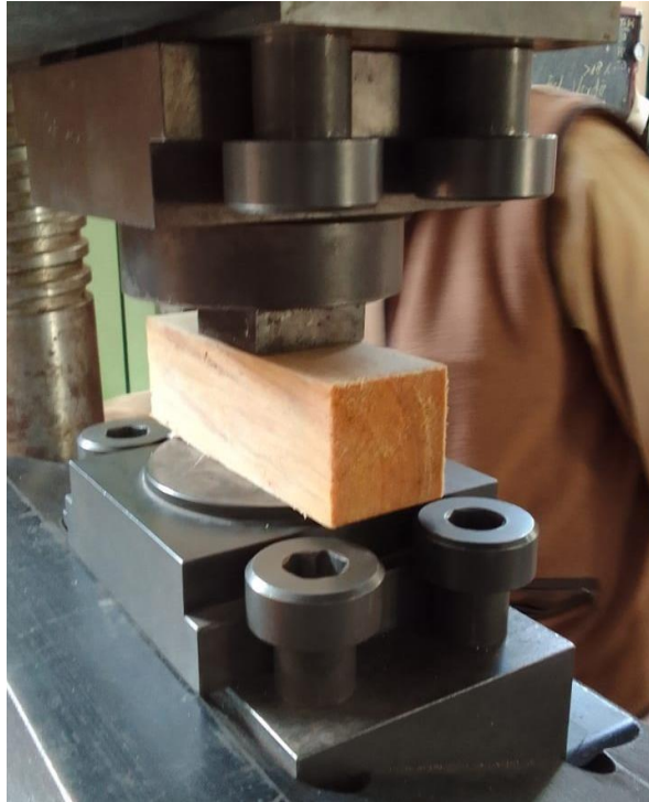
Foto 4. Compresión perpendicular al grano
