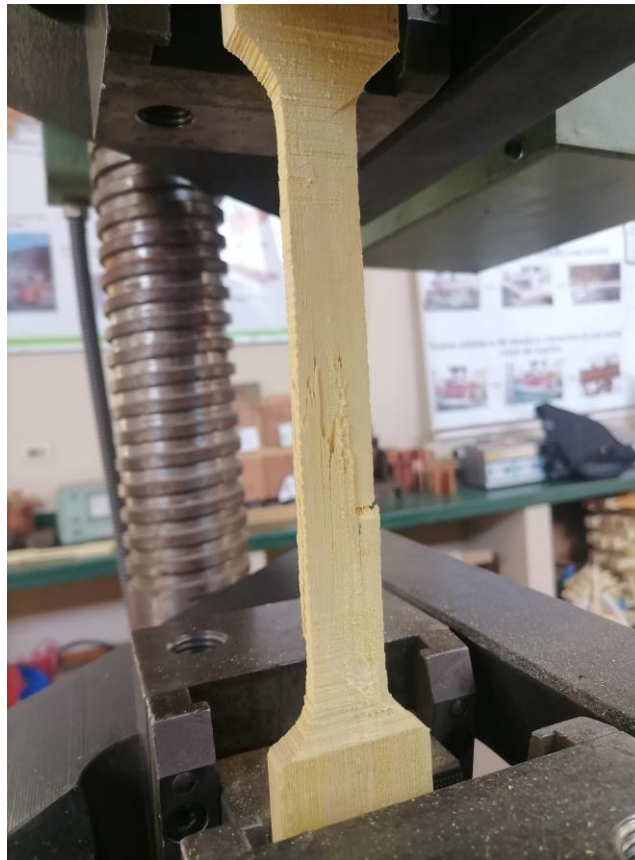
Foto 8. Ensayo de Tracción
