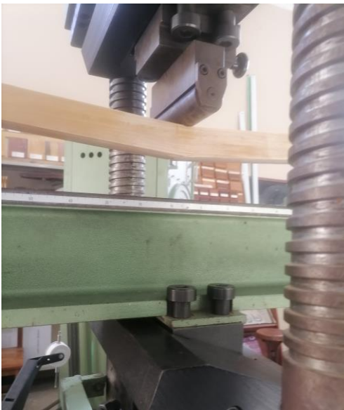
FOTO 5.- Falla de la probeta al ser sometida al ensayo de flexión en estado verde
