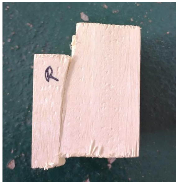
FOTO 13.- Falla de probeta al ser sometida al ensayo de cizallamiento en la prensa.
