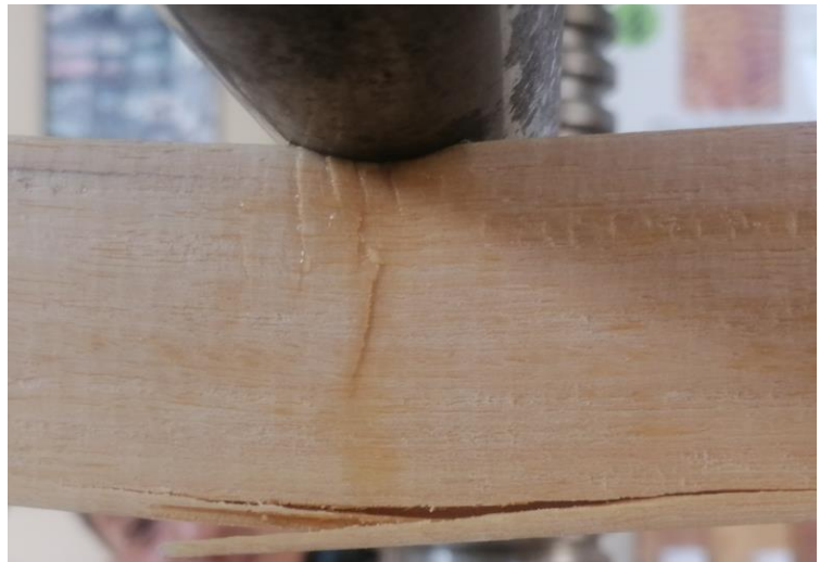
FOTO 5.- Falla de la probeta al ser sometida al ensayo de flexión en estado verde
