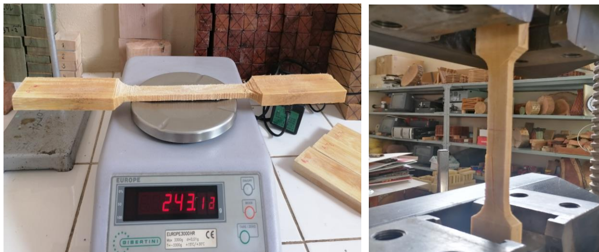
FOTO 14.- pesado de probeta y sometida al ensayo de tracción
