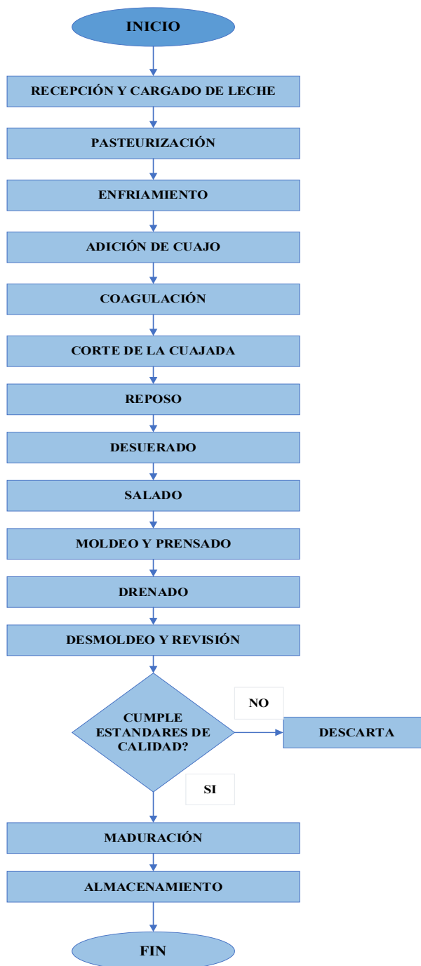
Figura 13 Diagrama de Flujo del proceso productivo del Queso fresco
