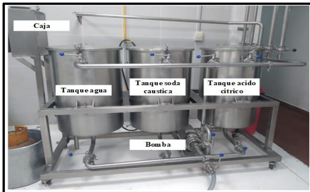
Figura 32 Tanques de Limpieza del sistema CIP del Área de lavado
