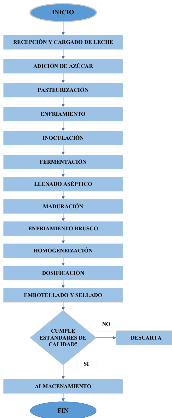
Figura 12 Diagrama de Flujo del proceso productivo del Yogur clásico de botella
