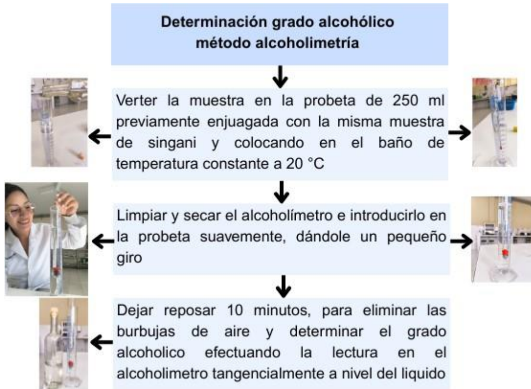
Figura 3.3 Procedimiento experimental para determinar el grado alcohólico
