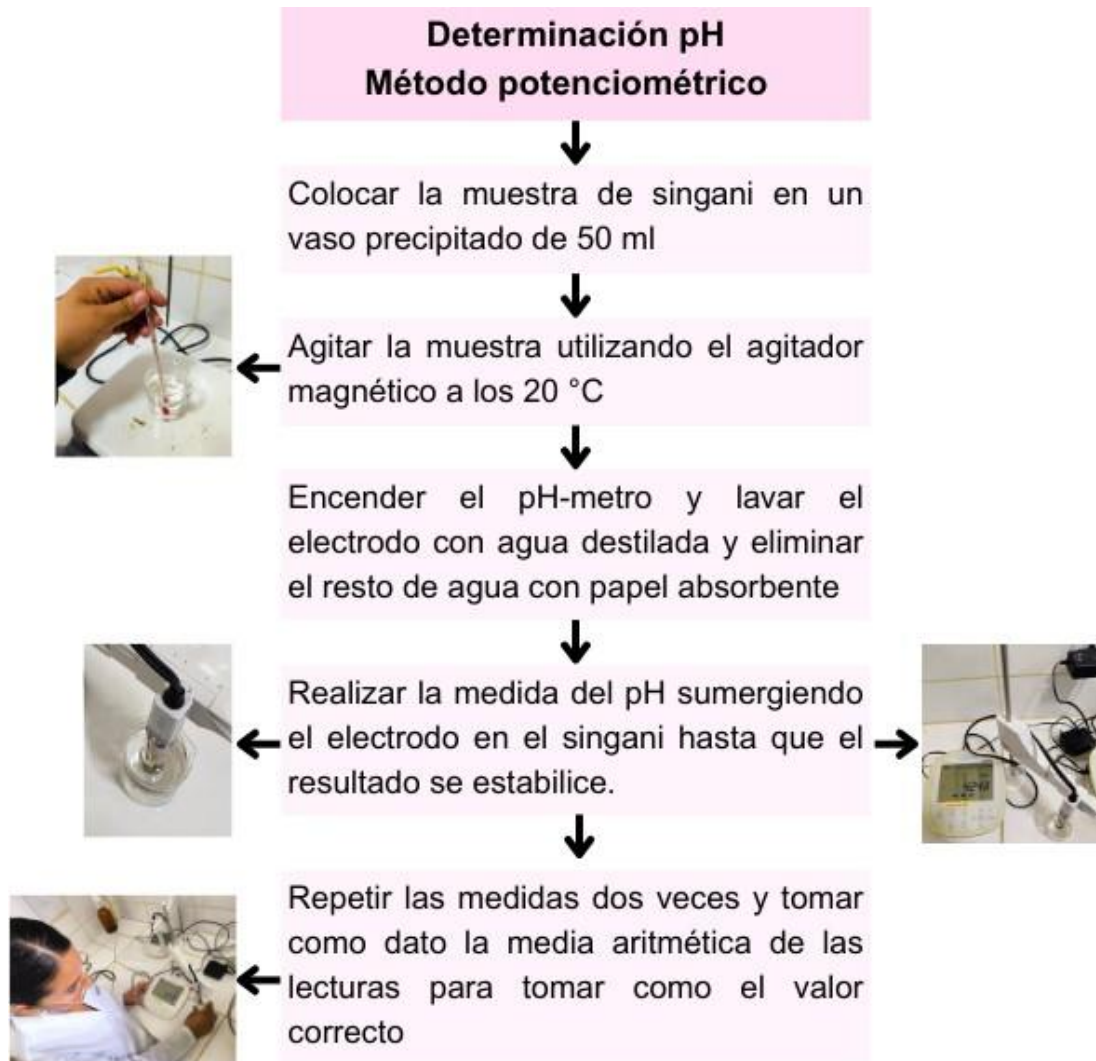
Figura 3.6 Procedimiento experimental para determinar pH
