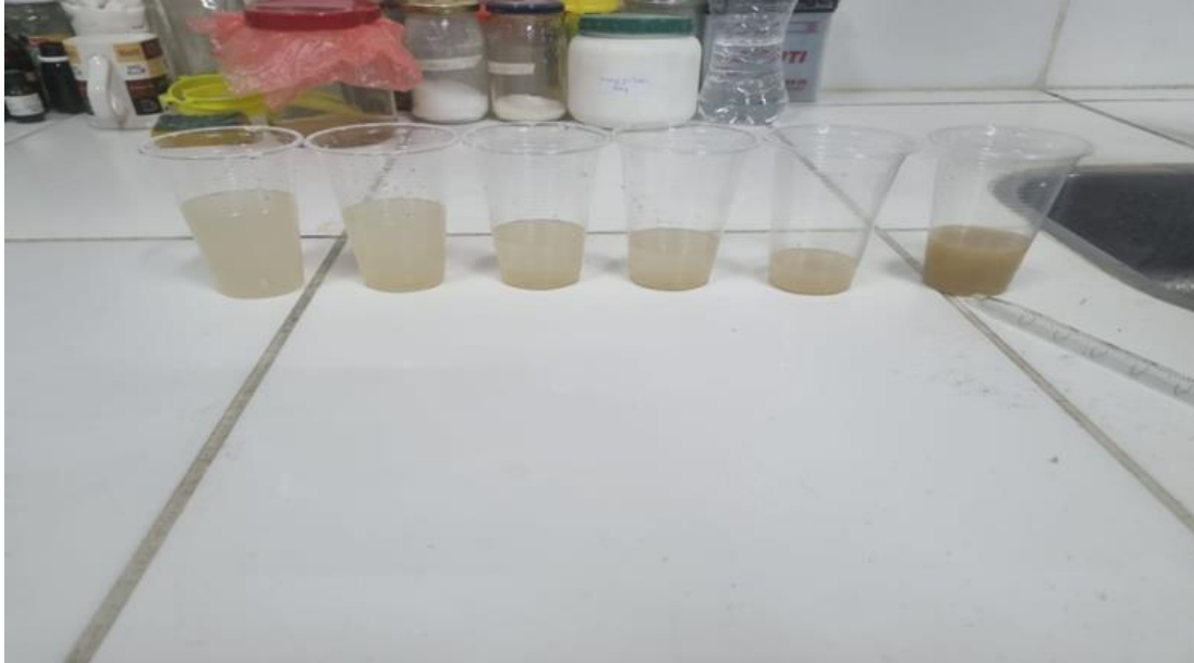
Fotografía 2-4. Preparación de patrones para su lectura en el espectrofotómetro.
