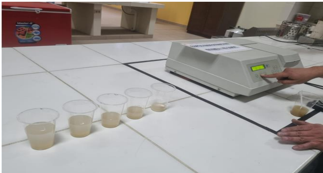
Fotografía 2-5. Lectura de absorbancia en espectrofotómetro.
