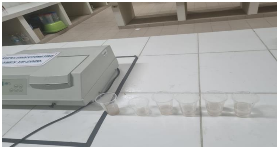
Fotografía 2-13. Lectura de absorbancia en espectrofotómetro.
