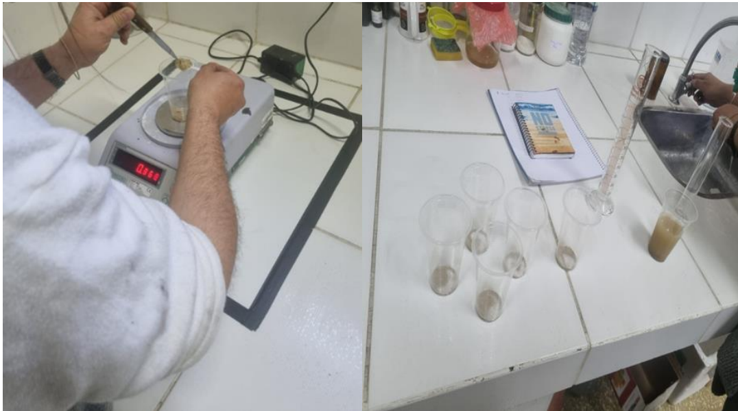
Fotografía 2-3. Pesaje de la arcilla para su disolución en distintas proporciones de agua.
