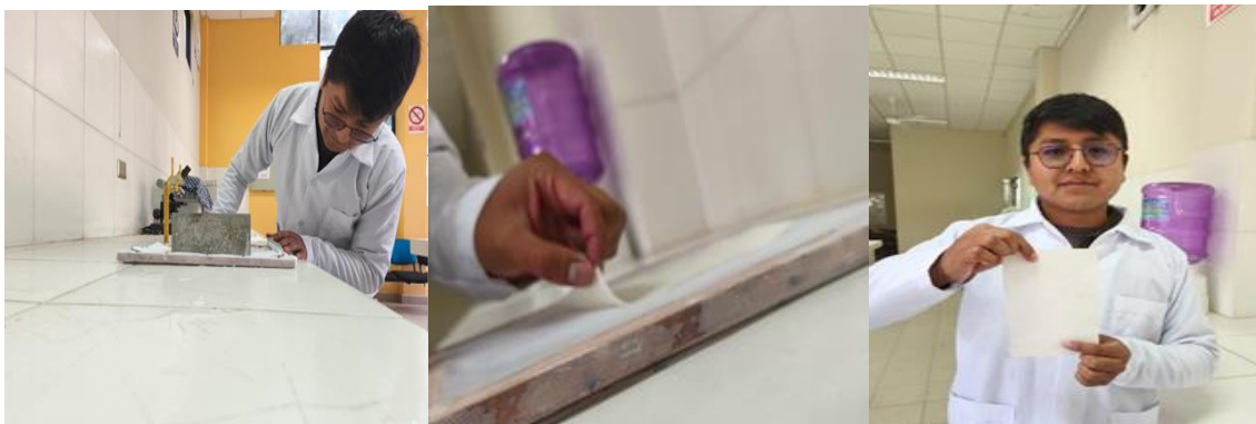
Figura 2-11: Secado del papel a partir de cascara de naranja
