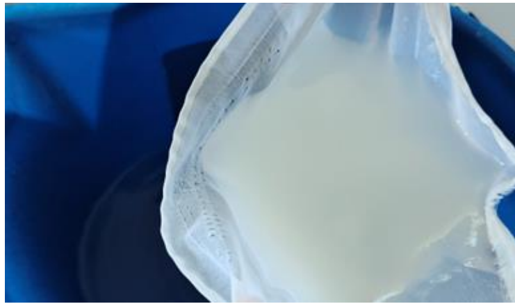
Figura 2-8: Escurrido y lavado de la pulpa blanqueada
