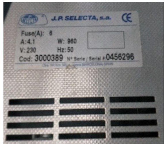
Figura II-4: Etiqueta de información del termostato para el equipo 1
