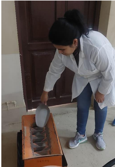
Figura II-6: Método del cuarteo aplicado en piedra caliza
