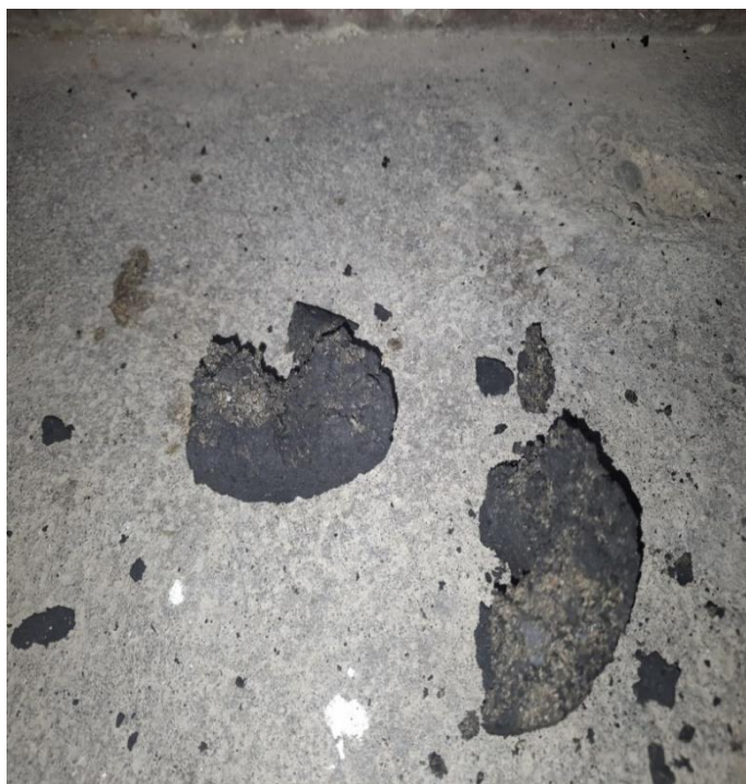
Fotografía N° 8 Prueba de friabilidad de las briquetas de carbonilla más aserrín y aglutinante almidón de yuca
