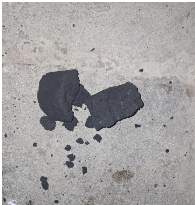
Fotografía N° 8 Prueba de friabilidad de las briquetas de carbonilla más aserrín y aglutinante almidón de yuca
